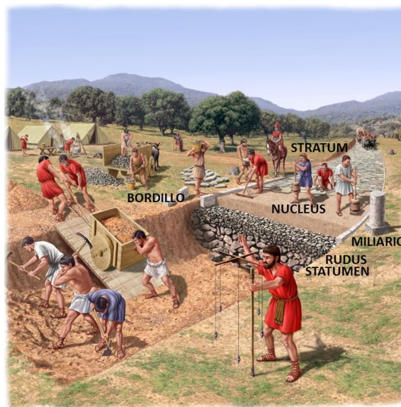
Figura 2-10. Construcción de una calzada romana. Fuente: Imagen cedida por el ilustrador Antonio Grajera.
