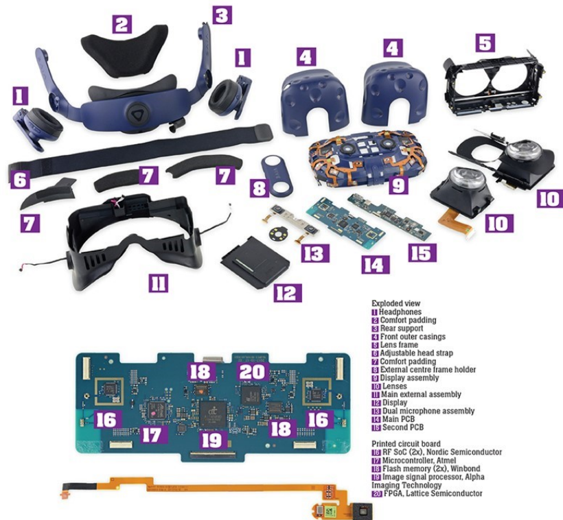
Figura 1.2: Despiece de todos los componentes del HMD en su versión HTC Vive. https://eandt.theiet.org/content/articles/2018/05/teardown-htc-vive-pro-vr-headset/
