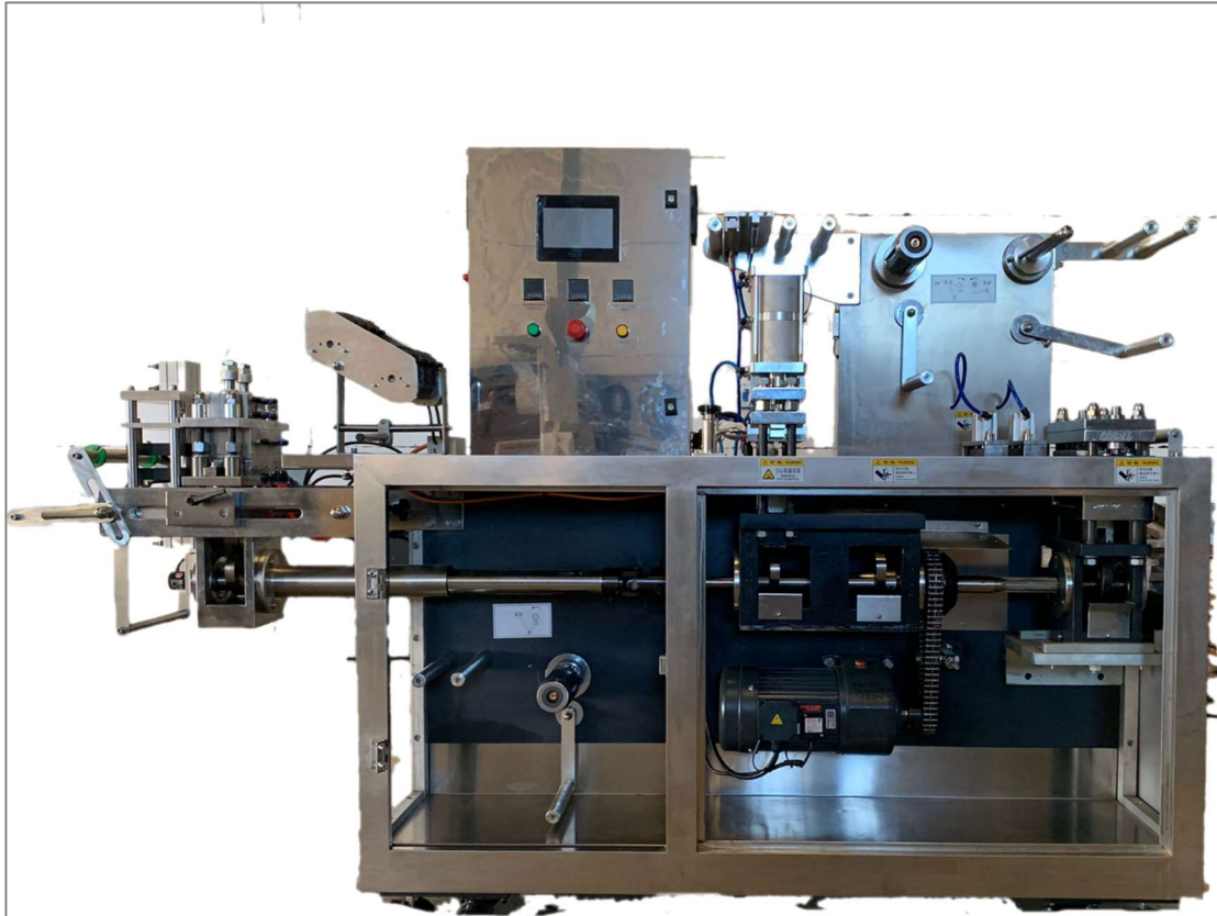
Figura (1). Máquina Termoformadora de terrinas, multietapa.
