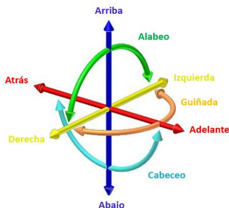
Figura 3.8. 6-DoF, seis grados de libertad: adelante/atrás (forward/back), arriba/abajo (up/down), izquierda/derecha (left/right), cabeceo (pitch), guiñada (yaw), alabeo (roll).
