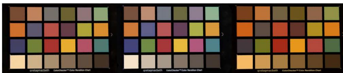
Figura 6.27. Efecto del cambio de fuente luminosa sobre el ColorChecker para simulador TL84 (izqda.), simulador D50 (centro) y simulador A (dcha.).
