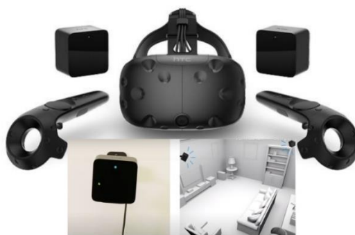
Figura 3.12. Visor HTC Vive y colocación de las estaciones base. Fuente: Adaptada Vive
