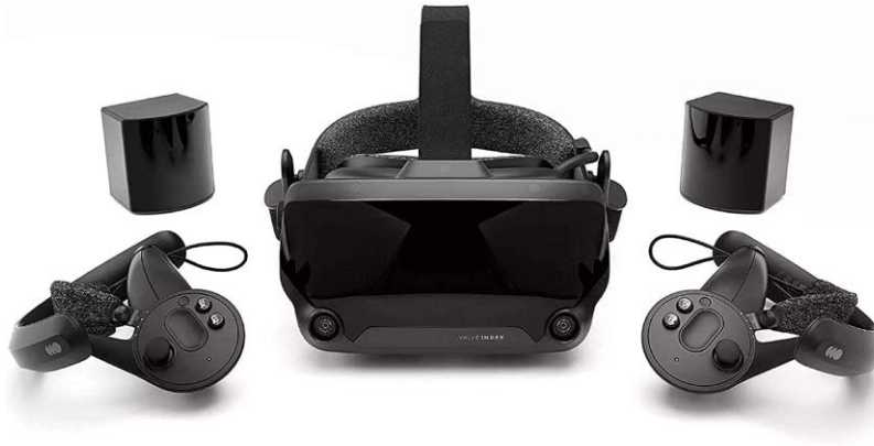
Figura 3.15. Imagen Valve Index con dos controladores y 2 estaciones base. Fuente: Valve Index
