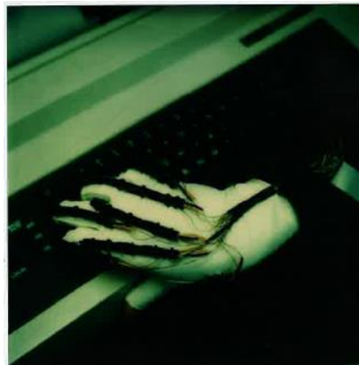
Figura 4.13. Sayre Glove. Los tubos negros son los transductores de ángulo que registran cuánto se dobla cada articulación. Fuente: [146]
