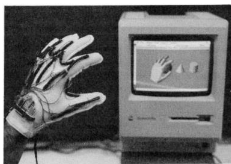
Figura 4.14. DataGlove de VPL de primera generación conectado a un Mac. Fuente: [147]
