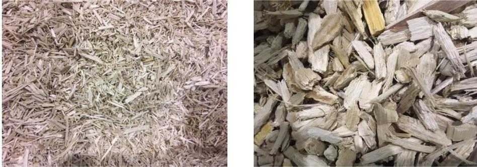
Figura 28. Biomasa cribada con distintos tamices (base y 8 mm).
