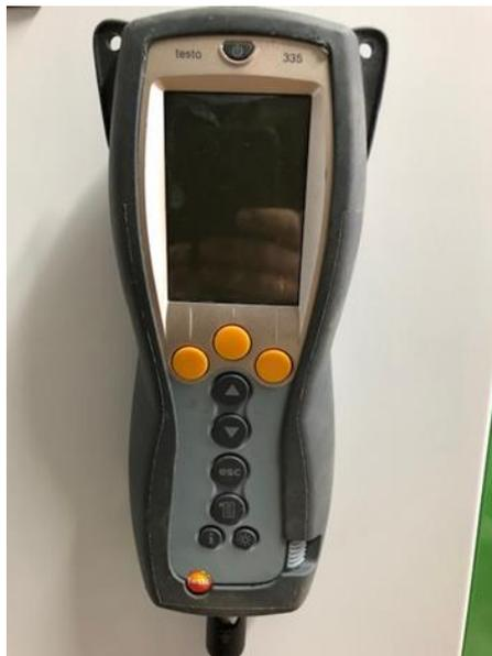
**Figura 22. Analizador de gases “Testo 335”**
