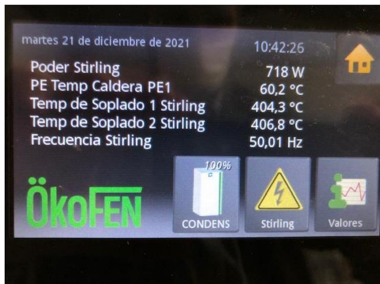
**Figura 118. Pantalla de información sobre la producción de electricidad generada en la caldera de condensación de los invernaderos de CICYTEX.**
