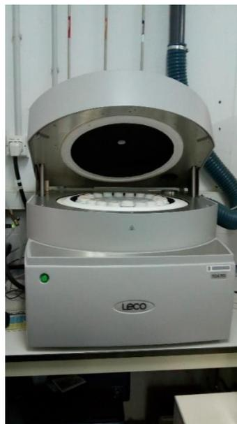
**Figura 15. Analizador TGA 701 Leco.**
