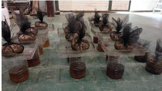
**Figura 30. Proceso de lavado de biomasa.**
