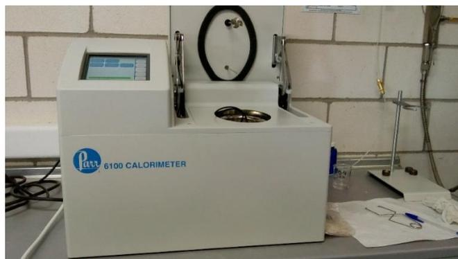
**Figura 14. Bomba calorimétrica 6100 PARR. Laboratorio de caracterización de biocombustibles. Finca la Orden. Cicytex.**
