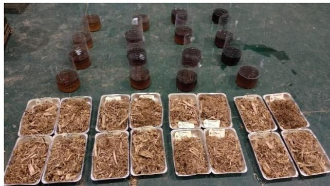
**Figura 31. Muestras de biomasa lavadas previo a su secado.**
