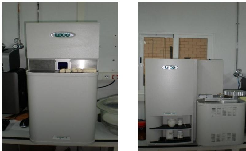
**Figura 16. Analizador elemental TrueSpec CHNS Leco 4084.**
