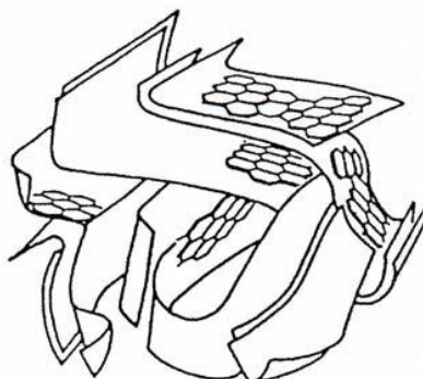
Figura 1.3. Esquema de la microestructura de un carbón activado.
