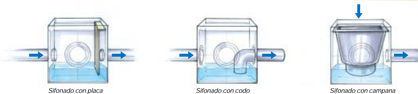
Fig. ES-01. Cierre hidráulico en arquetas
