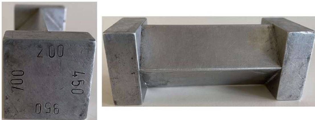
Figura 8. Diferentes perspectivas del instrumental Doctor Blade para diseñar películas con un grosor de 200, 450, 700 o 950 mm mediante solvent-casting .
