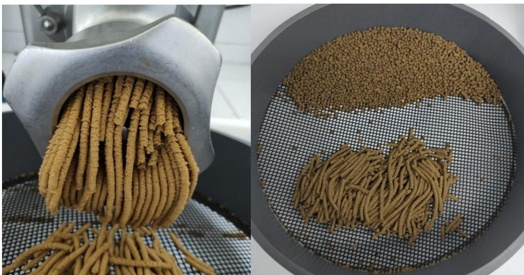
**Figura 9.** Picadora empleada en el experimento y proceso de formación de pellets mediante el tamizado de las tiras de pienso.
