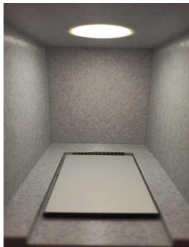
Figura 4-21: Cámara generada para aislar las gotas de los hidrogeles y permitir
