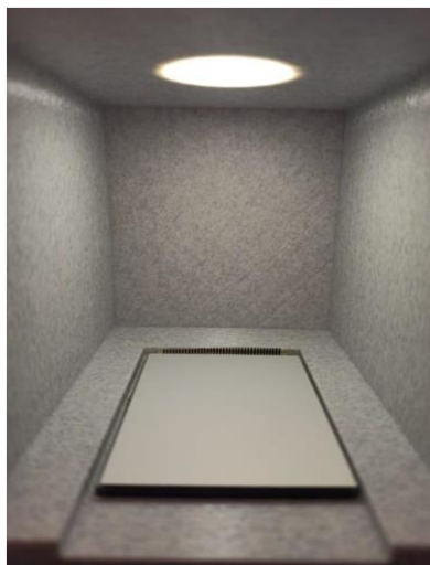
Figura 4-14: Cámara generada para realizar el método de gota sésil utilizando un lecho no absorbente e iluminación adecuada. Fuente: elaboración propia.
