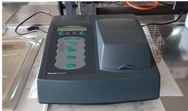
Figura 6. Espectrofotómetro utilizado para medir la densidad óptica.
