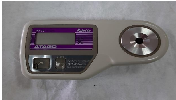
Figura 5. Refractómetro utilizado para medir los grados Brix.
