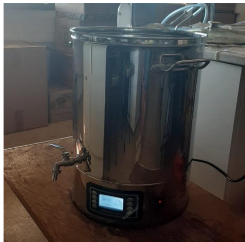
Figura 6. Olla programable con control de temperatura y tiempo utilizado para la elaboración de cerveza
