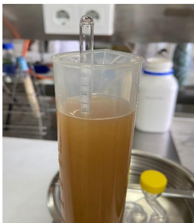
Figura 8. Medida de la densidad de la cerveza con el densímetro
