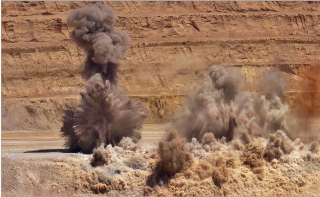
Figura 5. Emisiones de polvo generadas durante una voladura [20].
