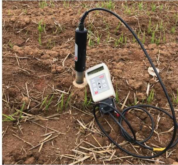
Figura 3.8. Lectura de humedad in-situ con la Sonda Delta- T Device Type PR-1.
