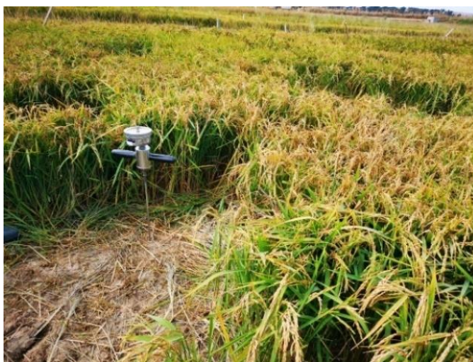
Figura 3.7. Medida in situ con penetrómetro de mano.
