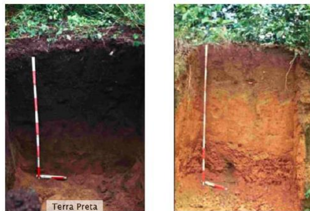
Figura 1.11. Comparativa de dos secciones de suelo, a la izquierda Terra Preta y a la derecha un Oxisol encontrado habitualmente en la cuenca Amazónica (Ladd et al., 2017).
