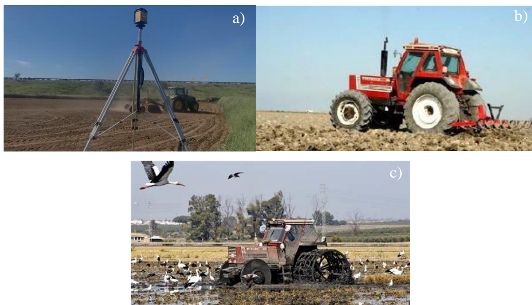
Figura 1.5. Nivelado (a); pase con grada de disco (b) y fangueo (c) en el cultivo del arroz.
