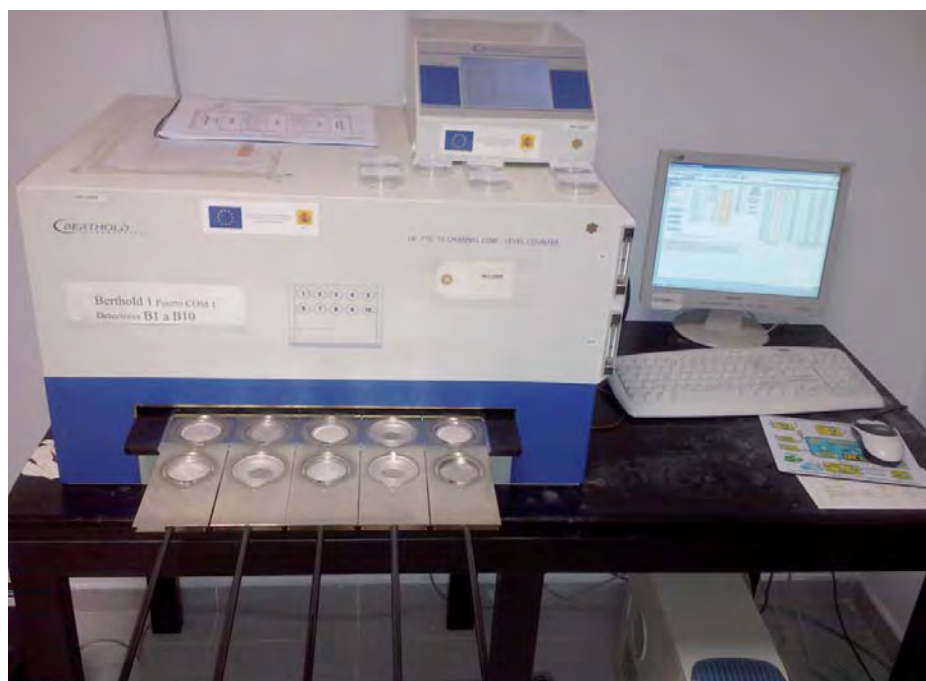
Contador proporcional de flujo de gas
