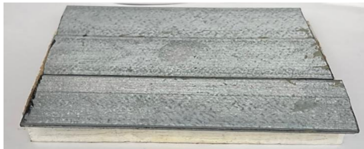
Figura 3.7. Base de madera cubierta con chapas metálicas para la preparación de las muestras en prensa hidráulica.
