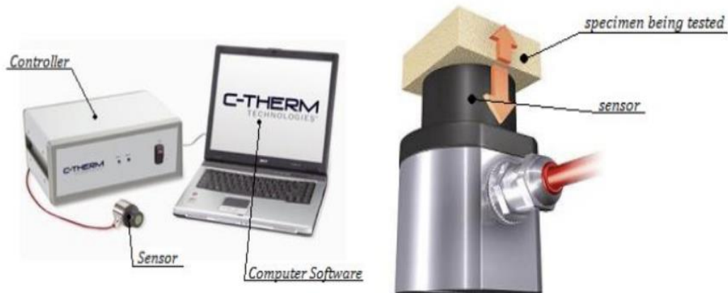
Figura 4.6. Analizador de conductividad térmica TCi (izquierda) y sensor de reflectancia térmica (derecha). Fuente: Venkataraman y Militky (2014).
