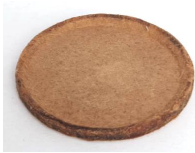
Figura 3.6. Disco de MDF empleado como compactador del molde de acero inoxidable para la preparación de las muestras a 1 y 2 t.
