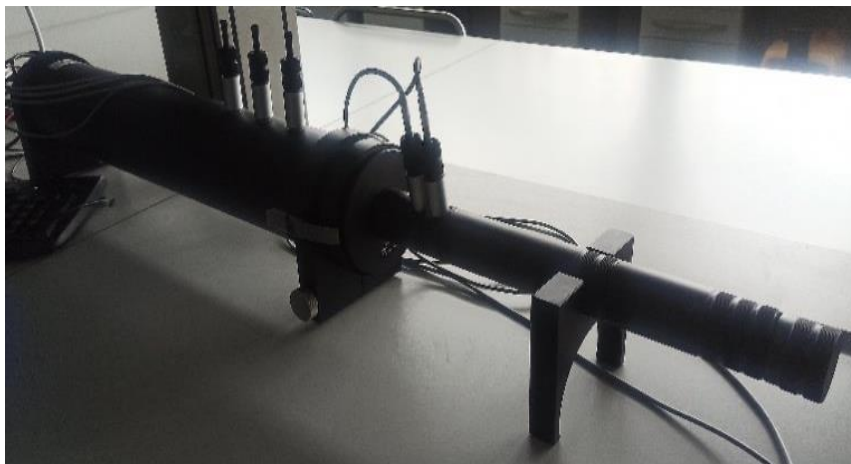
Figura 5.12. Disposición horizontal (abajo) del tubo de impedancia) y configuración del sistema (arriba) utilizados en la caracterización acústica de las muestras de este trabajo.
