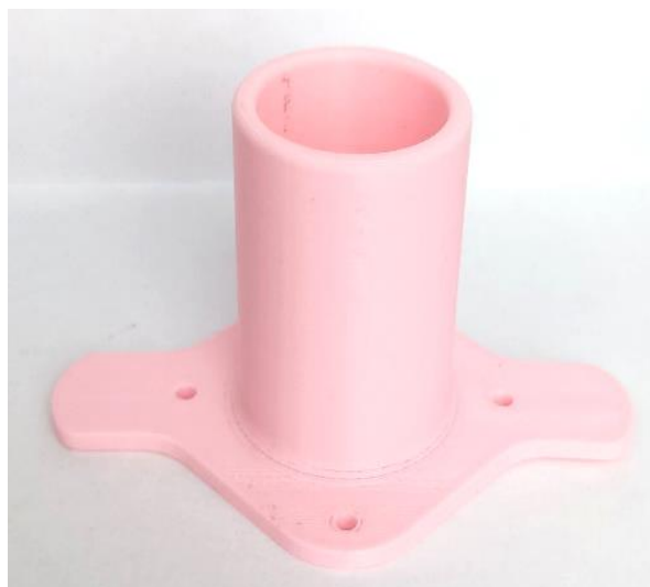
Figura 3.9. Molde de PLA impreso en 3D para la obtención de las muestras de 29 mm.
