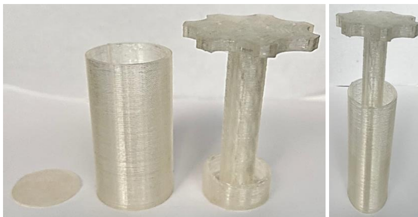
Figura 3.11. Molde impreso en PLA para la preparación de muestras por compactación manual.
