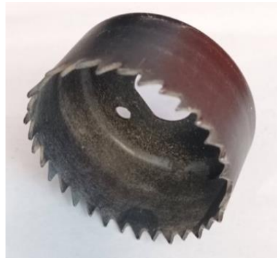
Figura 3.8. Broca de corona con dientes para el corte de las muestras empleando un taladro.
