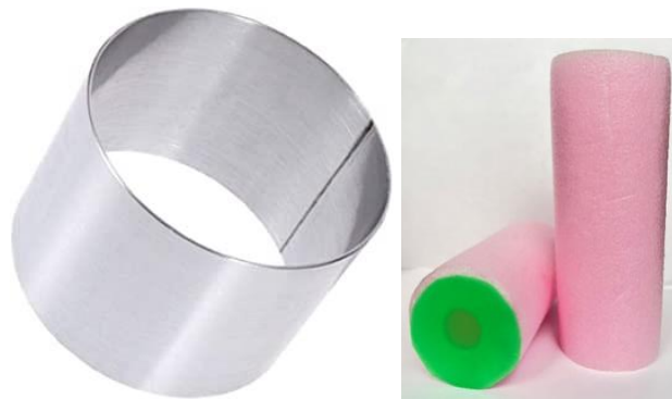
Figura 3.3. Molde de aluminio de 60 mm de diámetro utilizado en la preparación de las muestras y del pistón empleado para ejercer presión.
