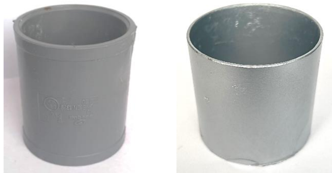
Figura 3.5. Moldes de PVC (izquierda) y acero inoxidable (derecha) empleados para la preparación de las muestras.
