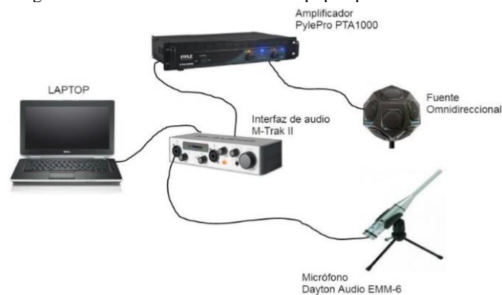
Figura 2. Configuración de las conexiones de los equipos para las mediciones realizadas
