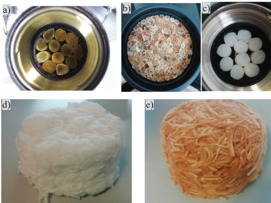
Figura 2. Ejemplos de muestras preparadas para las diferentes experiencias llevadas a cabo. Diámetros: a) y c) 29 mm de diámetro, b), d) y e) 100 mm. Uso: a), b) y e) colillas usadas c) y d) filtros nuevos. Constitución: a), b) y c) colocadas manualmente con distinta compactación. d) y e) disgregadas.
