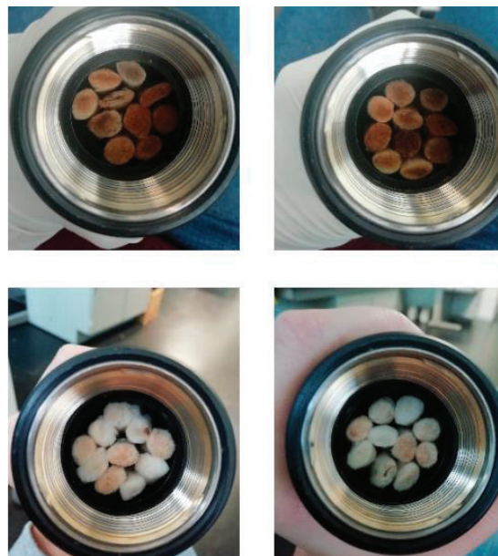
Figura 5. Ejemplo del efecto de la limpieza química en dos muestras elaboradas con colillas usadas. Figura superior: sin limpiar.
