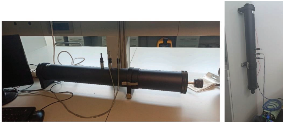
Figura 3. Tubo de impedancia empleado en disposición horizontal y vertical.
