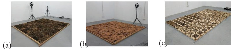
Figura 1. Las diferentes muestras de corcho bornizo ensayadas en la cámara reverberante. (a) S1; (b) S2; (c) S3.
