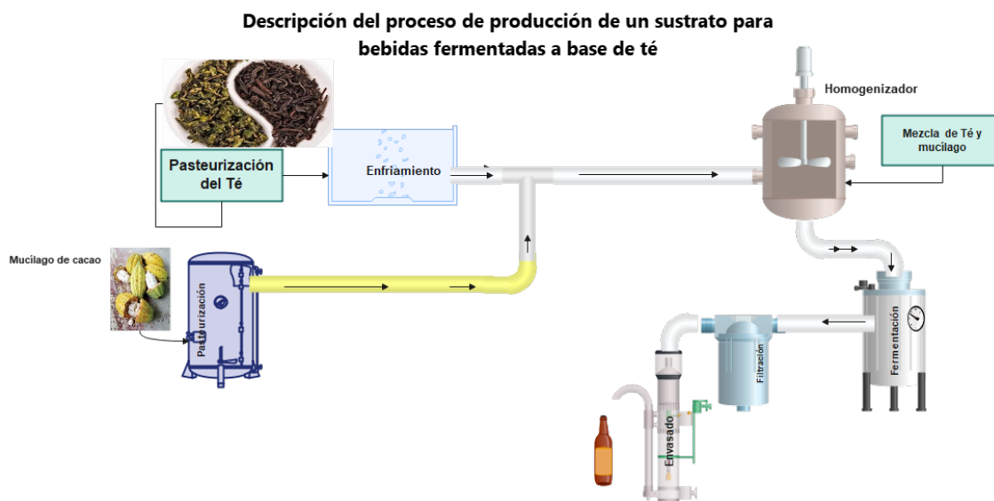
Figura IV.7. Esquema general de las etapas para la elaboración de bebida fermentada de té con adición de mucílago de cacao.
