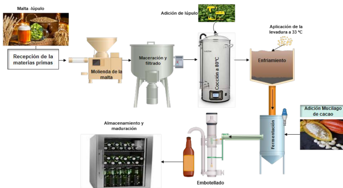
Figura IV.10. Esquema de los procesos de la elaboración de cerveza artesanal con la inclusión de mucílago de cacao.
