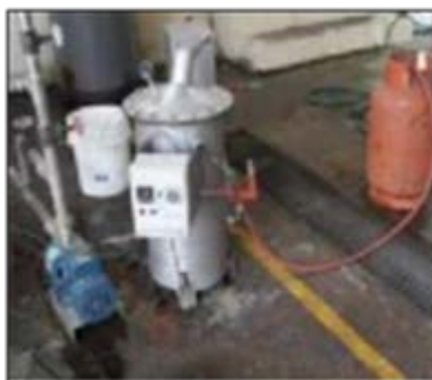
Figura IV.5. Destilador para la producción de bioetanol a partir de mucílago de cacao.
