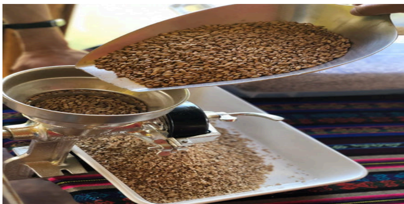
Figura IV.11. Imagen del proceso de molienda de la malta de cebada.
