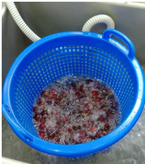
Figura VI.1. Cerezas siendo sometidas a higienización en agua a 5°C en hidrocóoler (Kronen, DS1000, Alemania).
