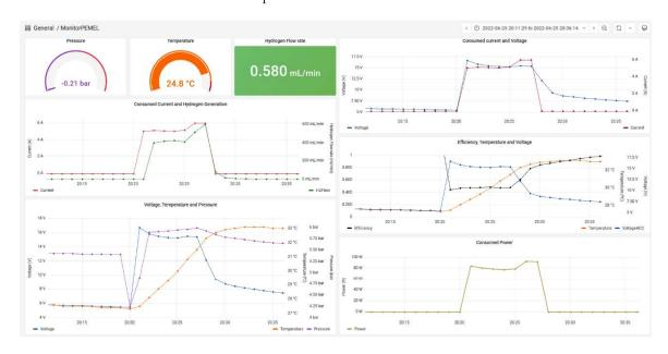
Figura 13. Sistema de monitorización implementado. *Dashboard* de Grafana en funcionamiento. (Fuente: Fig.6 artículo 2)
