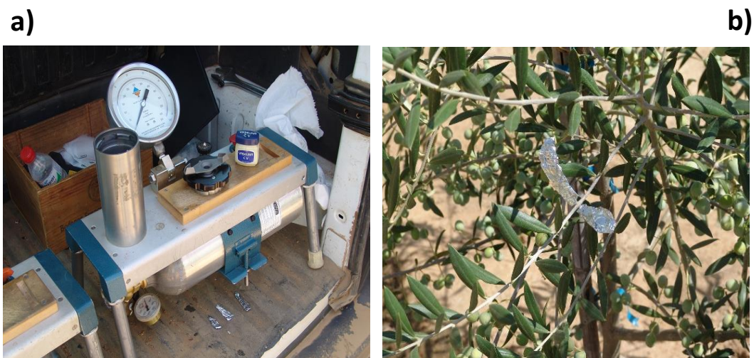
Figura 2.4. Cámara de presión tipo Sholander (Soil Moisture Equipment Corp., Model 3500, Santa Barbara, CA, USA) (a) y hoja cubierta con papel aluminizado para medir potencial hídrico de tronco (b).
