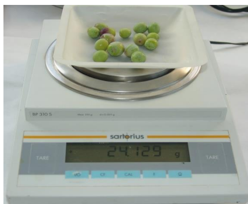
Figura 2.7. Peso fresco y seco (g) de muestras de aceitunas con balanza de precisión digital.
