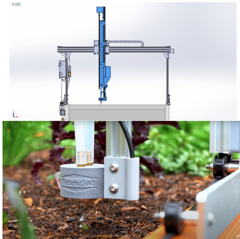
Figura 9.13: Izquierda: Estructura del robot con el brazo elevador indicado, elaboración propia. Derecha: Imagen del cabezal en contacto con la tierra, [25]
