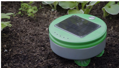
Figura 6.2: Robots para huertos urbanos. Izquierda: Tertill, robot escardador [73] Derecha: Sybil, robot escargador y sembrador [75]
