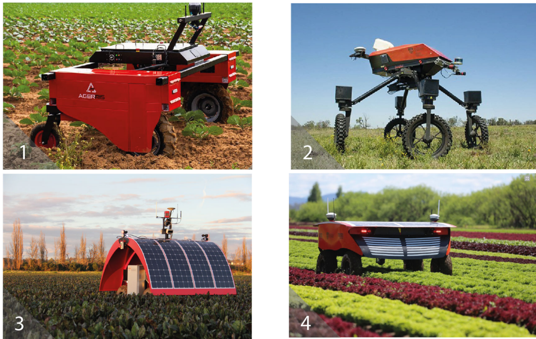
Figura 6.4: Tractores automatizados de Agerris, según el número de imagen: 1. Prototipo de tractor autónomo de arado, 2. Robot que monitoriza los pastos y elimina las malas hierbas, 3. Prototipo de tractor autónomo solar 4. Producto final de tractor autónomo solar llamado Digital Farmhand [78].
