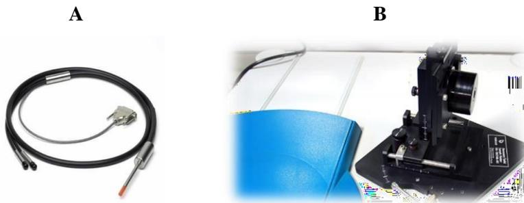
**Figura 12.** Dispositivos para el uso de fibra óptica (A) y fluorescencia ‘*front-face*’ (B).
