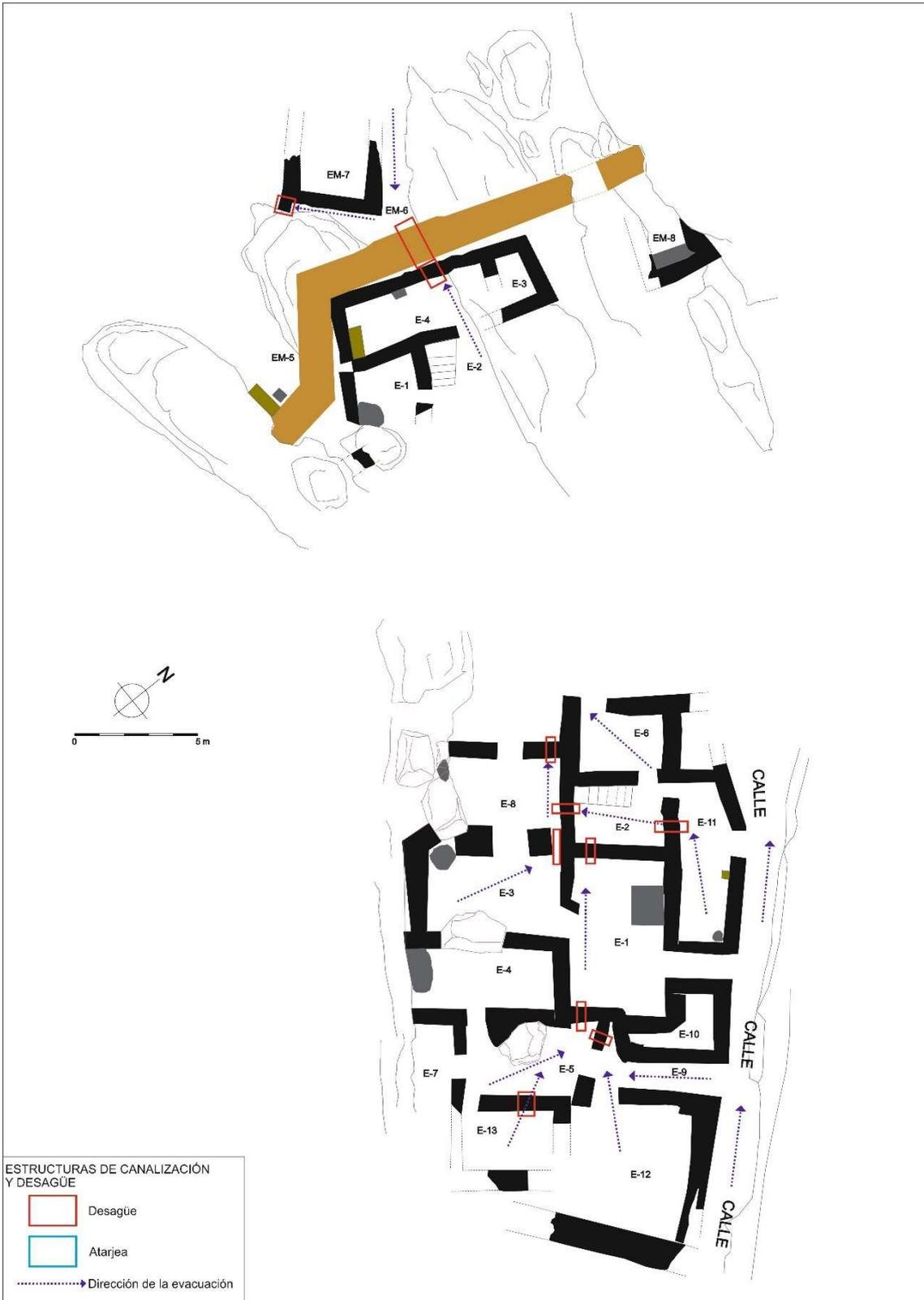
Fig. 198. *Distribución de estructuras de canalización y desagüe en los interiores de la fortaleza andalusí*
