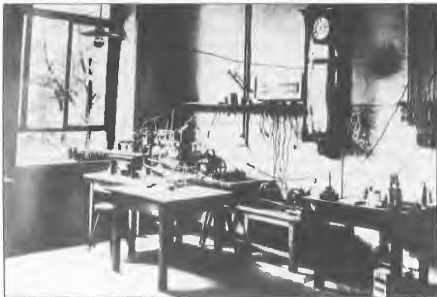
La descripción del laboratorio sería<sup>3</sup>: sobre la mesa de madera, más bien parece una mesa de cocina, cerca de la ventana había colocado un tubo de vacío de Hittorf-Crookes. A su espalda, en una mesa auxiliar algo más baja, un carrete de Ruhmkorff con su bobina de cobre y sus aisladores de cristal en forma de columna, rematados por un capuchón dorado de latón, conectaban con el tubo de cristal a través de dos delgados cables.
