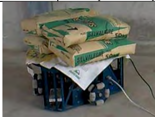
Figura 17: Robot Móvil Omni-direccional con 200kgf de carga.
