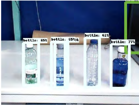
Figura 3: Ejemplos de botellas de plástico detectadas con inference server desde la cámara RGBD de la cabeza
