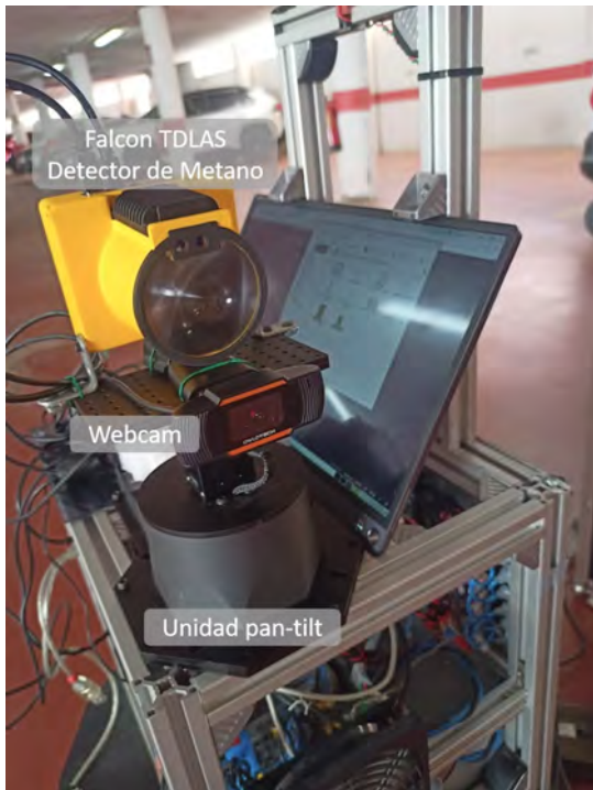
Figura 9: Vista detallada de la unidad pan-tilt equipada por Rhodon (el robot líder), la webcam utilizada para detectar el marcador Aruco en la plataforma Giraff-X (el robot seguidor), y el detector de metano Falcon TDLAS.
