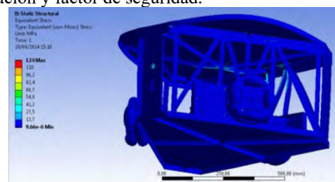
Figura 8: Esfuerzo equivalente Von Mises de la plataforma.
