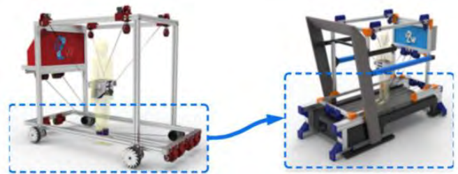
Figura 1: Sistema robótico Discover2Walk. Se observa el prototipo del exoesqueleto flexible para el estudio de movimiento del niño, además se distinguen los diferentes actuadores que ayudan al movimiento de los miembros inferiores, dándoles cierto grado de libertad. También se ve el cambio entre el sistema de tracción y la cinta de correr (Delgado-Oleas et al., 2023).
