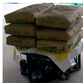
Figura 18: Plataforma con 300kgf de carga.
