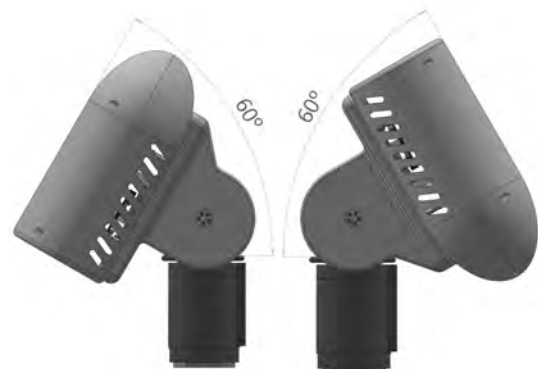
Figura 6: Rango de movimiento completo de la articulación frontal del cuello.
