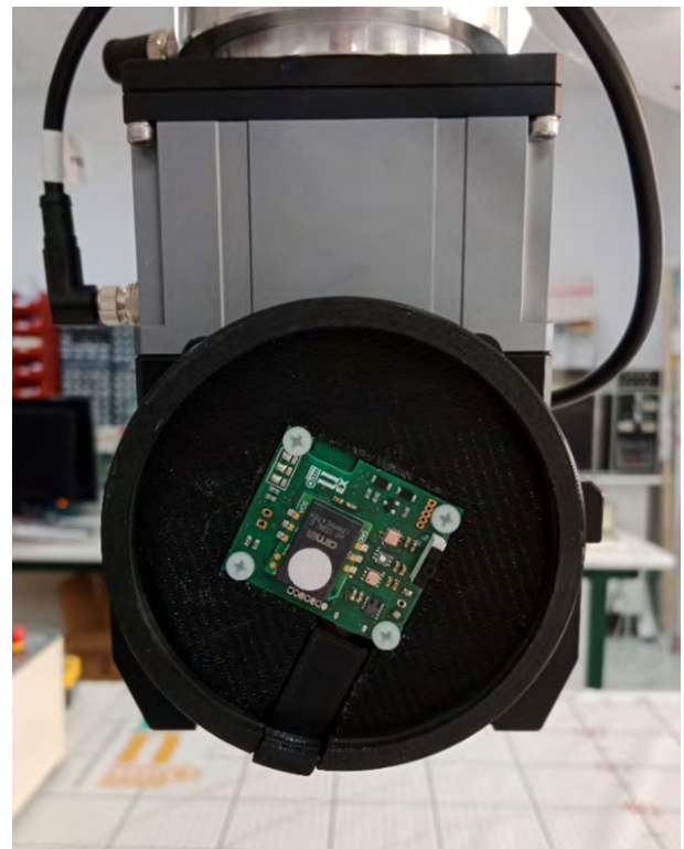
Figura 3: Nariz electrónica en la carcasa impresa en 3D y acoplada a la pinza del brazo robótico.
