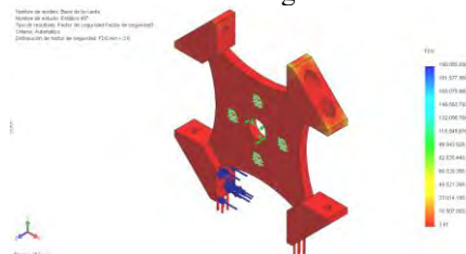
Figura 7: Factor de seguridad de la placa – base.
