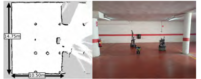
Figura 8: Configuración experimental. (Izquierda) Mapa de ocupación con dimensiones. (Derecha) Imagen tomada durante uno de los experimentos donde se identifican los dos robots involucrados, Griaff-X a la izquierda, y Rhodon a la derecha.
