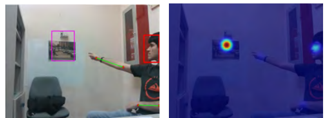
(a) Detección de la cara, brazos y estimación de la región de atención. (b) Mapa de atención. Aparece resaltada la cara del usuario y el foco de atención donde apunta.
