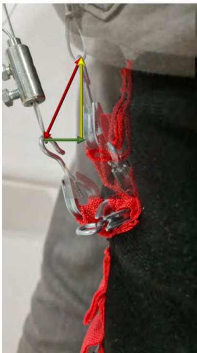
Figura 7: Compensación de muelle inverso activada que ayuda a mitigar la holgura de cables y textiles, y el backlash.
