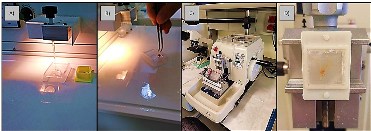
Figura 13. Dispensador de parafina líquida (A), orientación de la muestra en el molde (B), microtomo de rotación (C) y detalle de colocación en portamuestras de bloque retallado (D).
