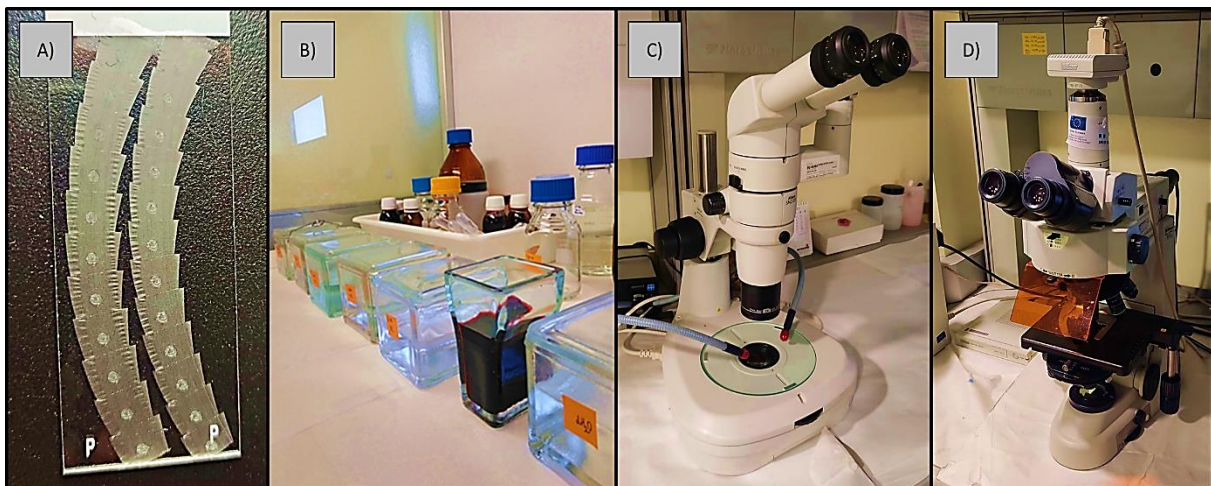
Figura 14. Resultado de los portaobjetos con las secciones obtenidas (A), batería de tinción de los cortes realizados (B), detalle de la lupa binocular (C) y retrato del microscopio óptico (D).
