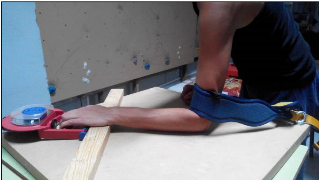
Figura 4.64. Sistema para la medición de la fuerza de dedos específica en escaladores.
