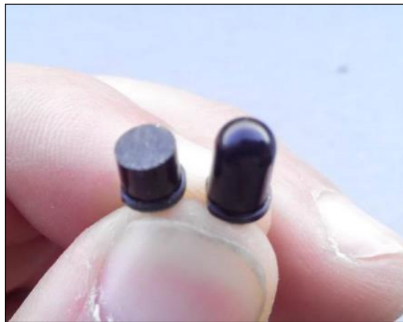
Figura 4.10. Detalle de la modificación del LED con forma aplanada para aumentar el ángulo de iluminación.
