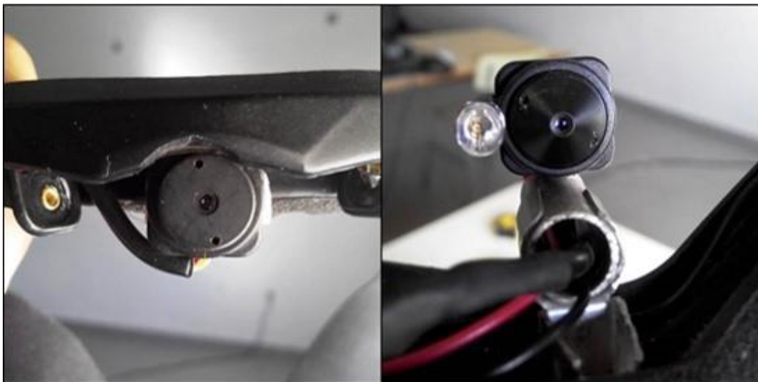
Figura 4.56. Detalle de la cámara de la escena (izq.) y del ojo (dra.) empleada en el sistema tecnológico de registro ocular.
