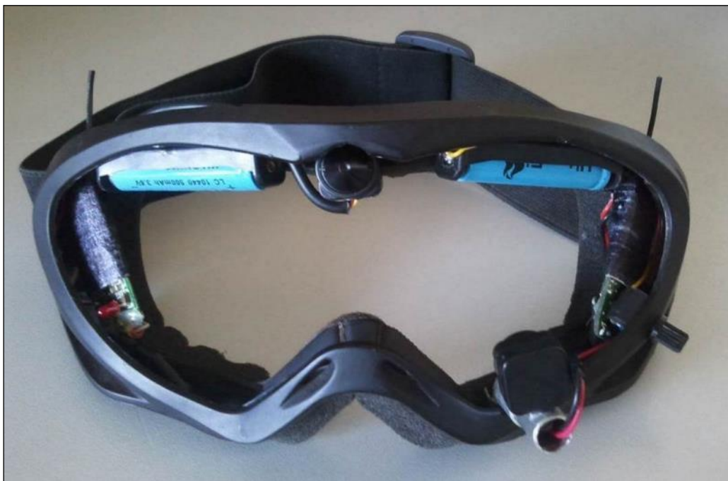
Figura 4.26. Prototipo final terminado con el que se lleva a cabo la fase de validez y fiabilidad del dispositivo de medida.
