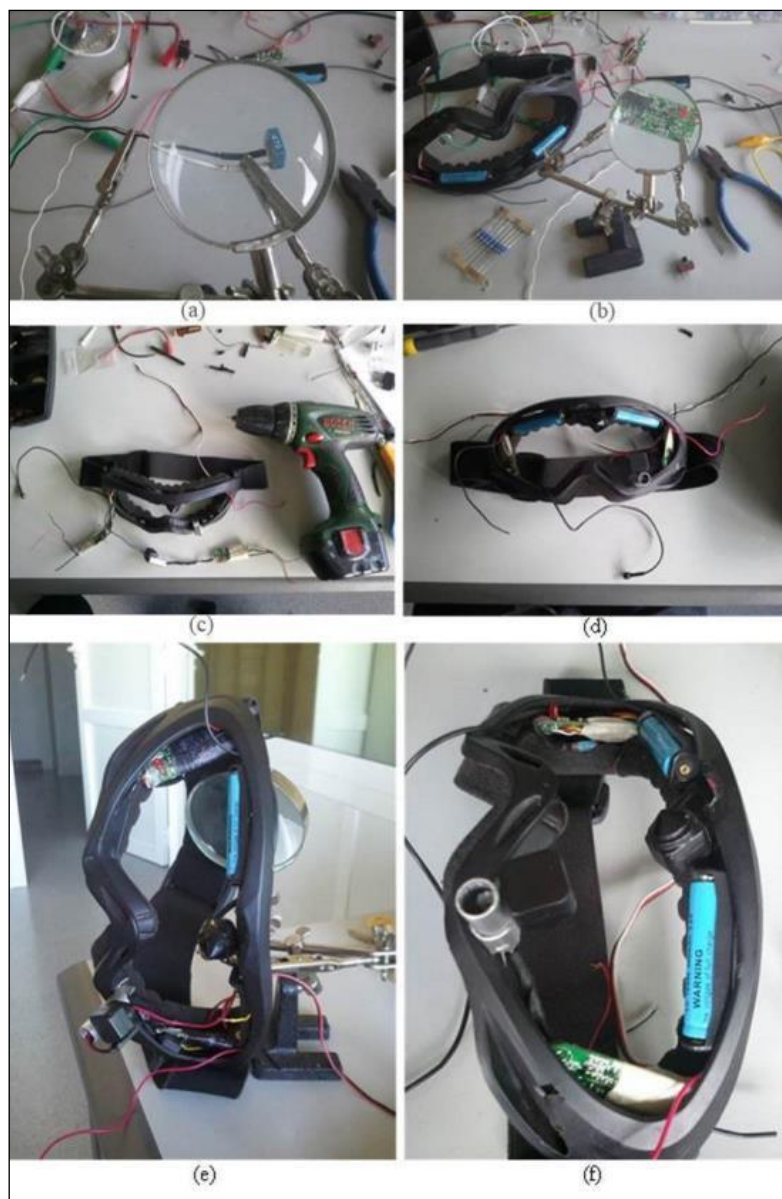
Figura 4.25. Proceso de montaje del segundo dispositivo: Soldado de resistencia regulable (a) y microcontroladora (b), perforación de estructura para hacer hueco a los componentes (c), colocación del micrófono y distribución de cables (d), instalación del LED (e) y prototipo en fase final de acabado (f).
