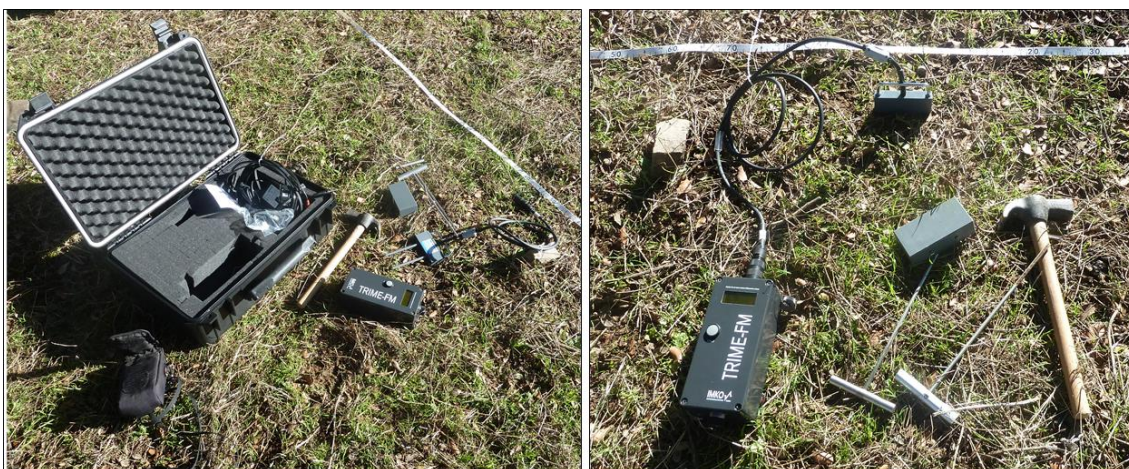
Fig. 4-14: Dispositivo manual TDR utilizado para las mediciones puntuales de humedad del suelo.
