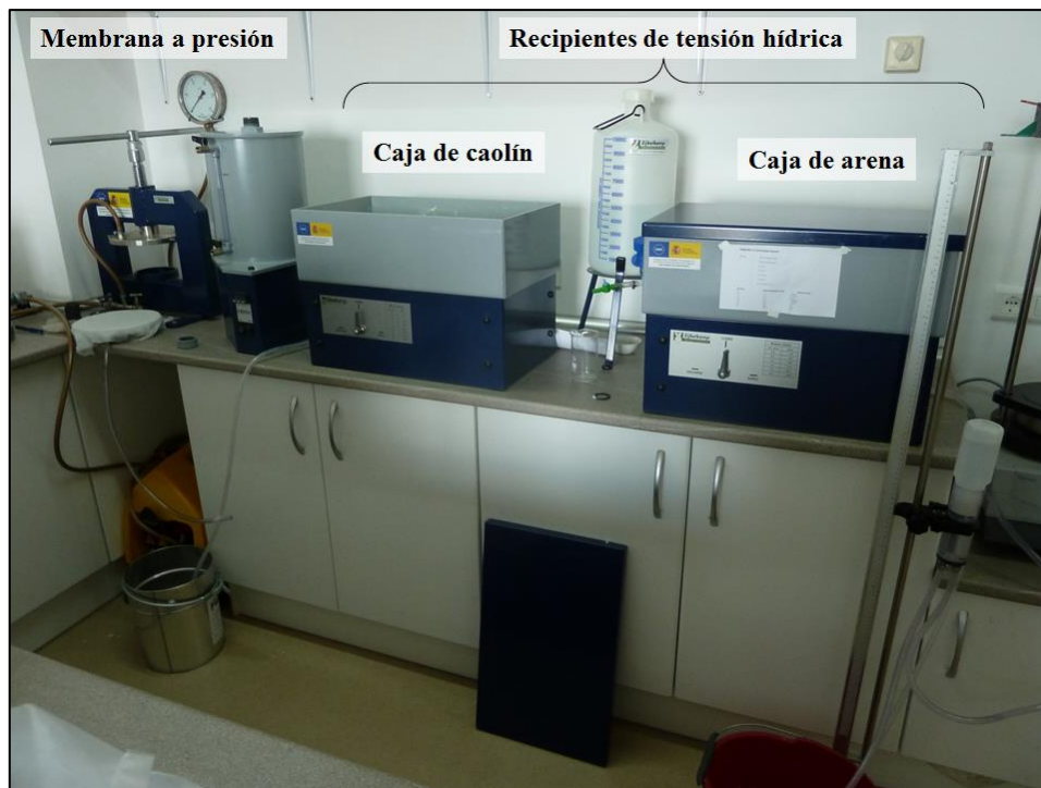
Fig. 4-22: Set de instrumentos utilizados para determinar los puntos de la curva de retención hídrica de los suelos. Laboratorio de Geografía Física de la Universidad de Extremadura.
