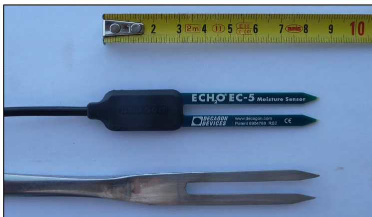
Fig. 4-2: Sensor de capacitancia modelo EC-5 (centro) para monitorizar la humedad, y guía utilizada para la instalación del mismo (abajo).
