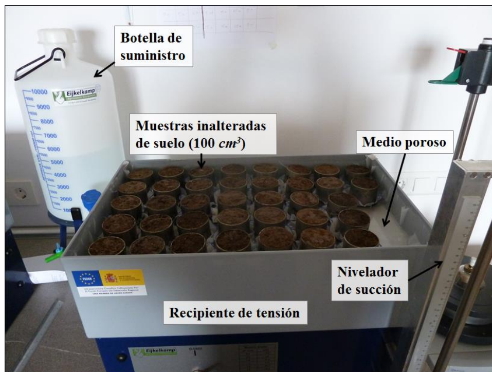
Fig. 4-23: Recipiente de tensión hídrica que se corresponde con la Caja de Arena, donde se aplican succiones a muestras inalteradas de suelo a través de un medio poroso.
