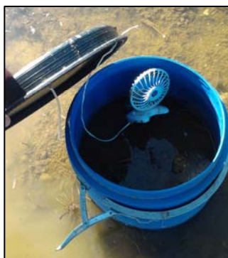
Figura 4.6.2. Campana de polietileno con ventilador en su interior y sistema de cableado.
