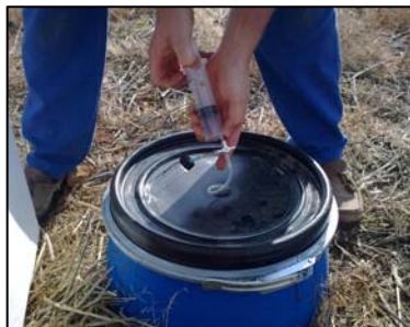
Figura 4.6.1. Recogida de gases del interior de la campana en viales de vidrio estancos.
