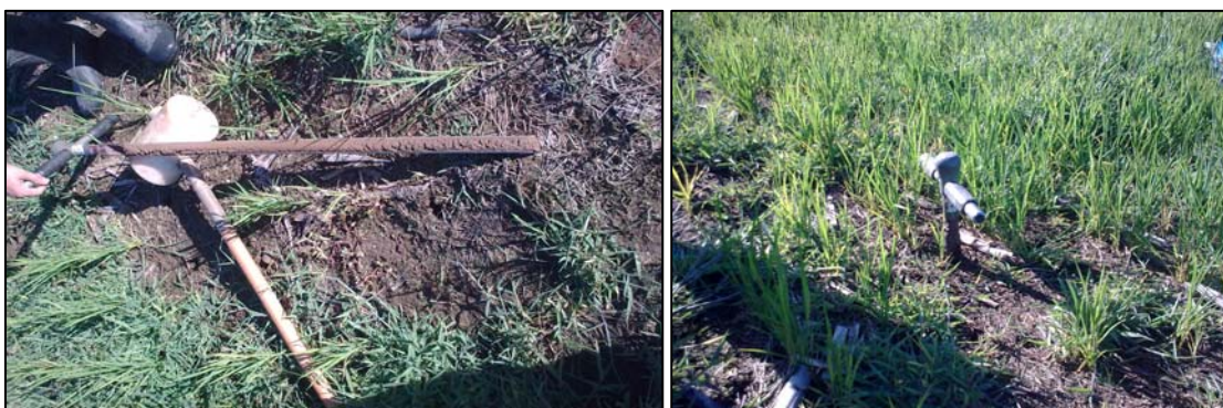
Figura 4.5.1.4.1. Barrena y mazo (izquierda); toma de muestra hasta un metro de profundidad (derecha).
