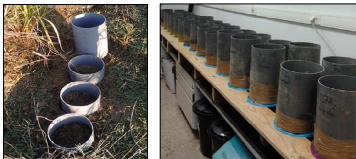
Figura 4.5.1.3.2.1. Columnas inalteradas utilizadas en el experimento de lixiviación.
