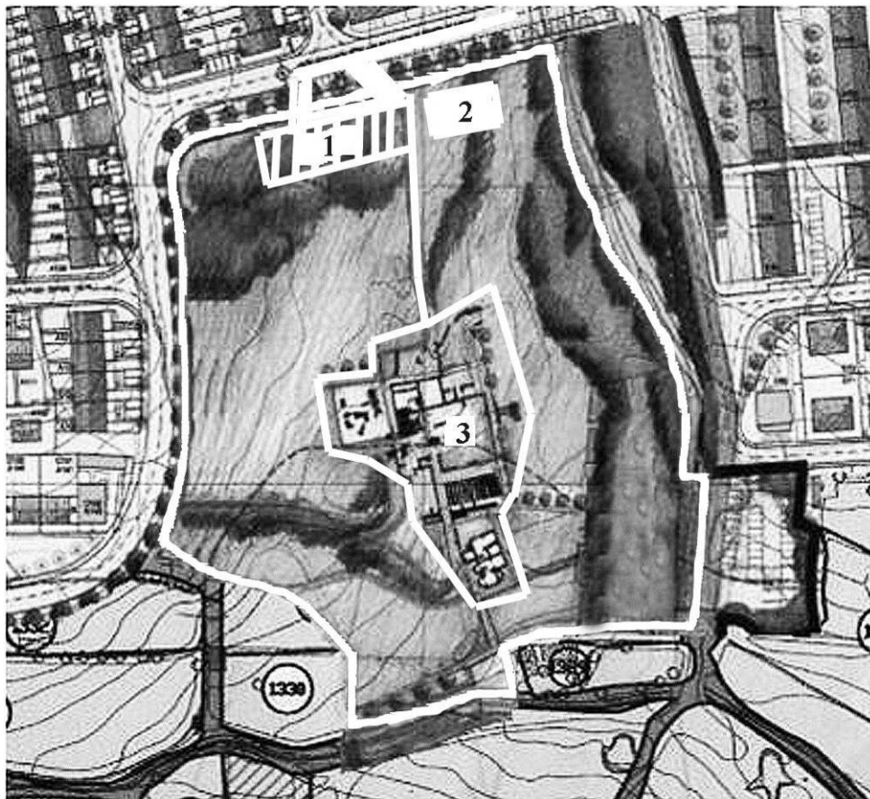
Fig. 327. – Projecto de musealização de Freiria. 1, parque de estacionamento; 2, local a construir as instalações de apoio; 3, ruínas a visitar. Base projecto do Arq. José Bicho.
