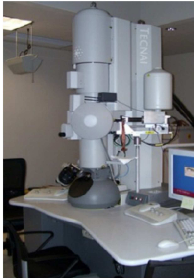
Figura 3.4. MET Tecnai G 2 20 usado para la caracterización microestructural de los polvos y sus mezclas, así como en materiales masivos
