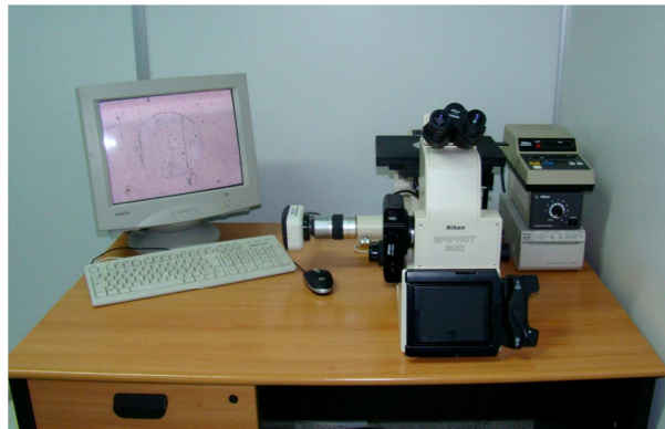
Figura 3.21. Microscopio óptico utilizado para capturar las imágenes de las improntas residuales en los ensayos de indentación Vickers y de desgaste por deslizamiento lubricado.
