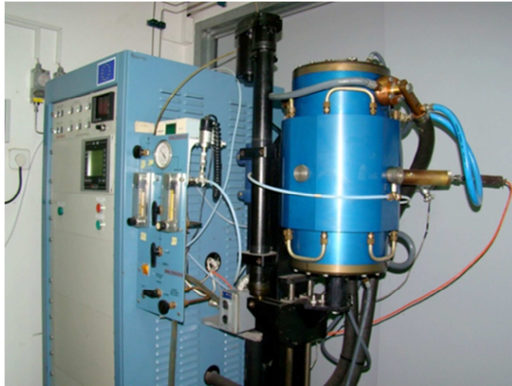
Figura 3.14. Horno de grafito de alta temperatura y atmósfera controlada utilizado para las sinterizaciones sin presión.
