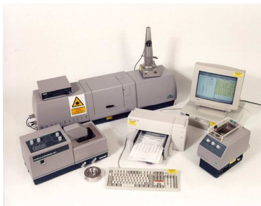
Figura 3.1. Equipo de dispersión láser empleado para la medida del tamaño de partícula en el régimen submicrométrico.
