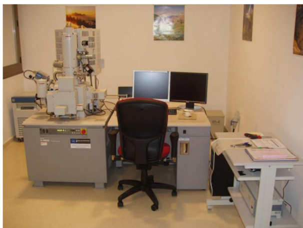
Figura 3.6. MEB de emisión de campo de la marca Hitachi empleado en la caracterización microestructural de los materiales masivos.
