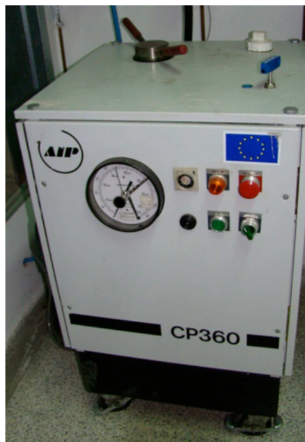
Figura 3.12. Prensa isostática utilizada para la compactación de los polvos.
