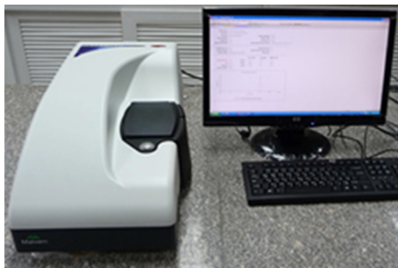
Figura 3.2. Equipo de dispersión láser empleado para la medida del tamaño de partícula en el régimen nanométrico y también para las medidas del potencial zeta.
