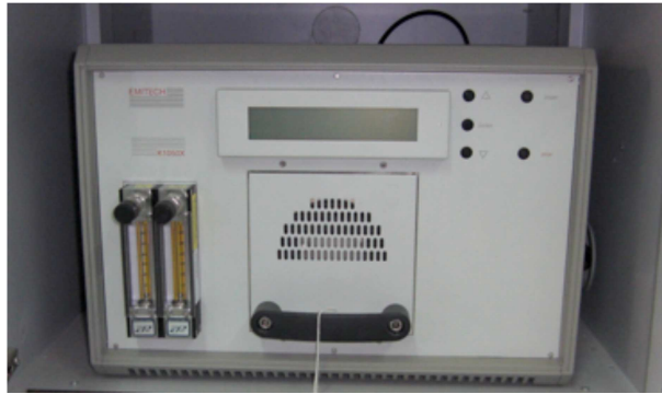
Figura 3.19. Marcador de plasma utilizado para revelar la microestructura.
