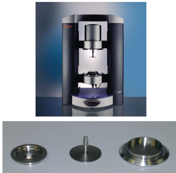
Figura 3.10. Reómetro y sensor DC60/2° empleado en las medidas reológicas.
