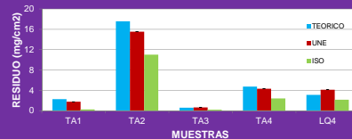
Comparación de los residuos teóricos esperados (calculados a partir de la ecuación descrita anteriormente), los residuos experimentales obtenidos usando la norma UNE y residuos experimentales obtenidos usando la norma ISO.
