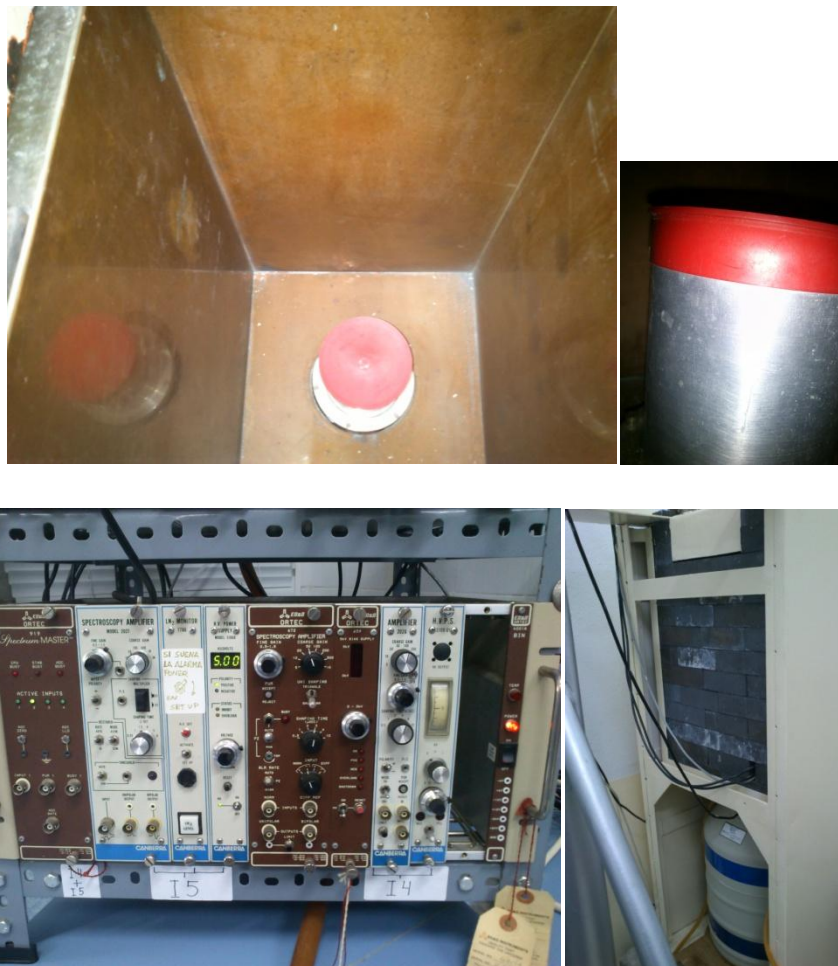
Figura III.2. Detector HpGe tipo p de la marca CANBERRA y electrónica asociada.
