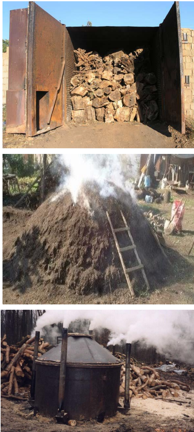
Figura I.1. Hornos para la fabricación de carbón vegetal.
