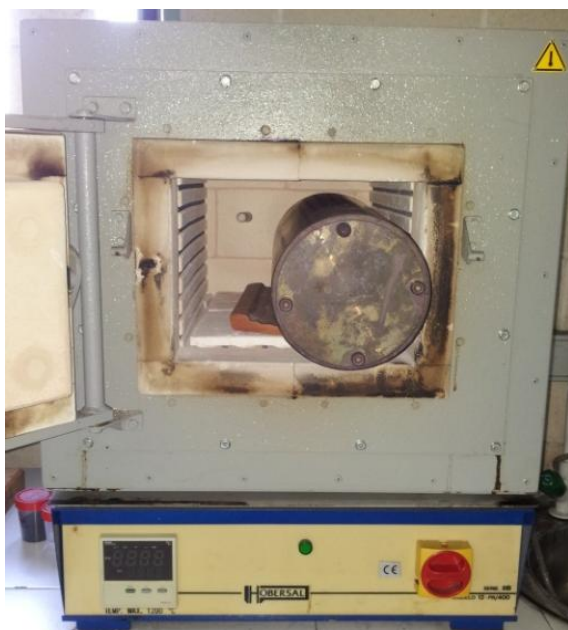
Figura II.1. Fabricación de carbones en condiciones controladas: a) Reactor con dedo para salida de gases, b) Horno Hobersal con reactor cerrado en su interior.
