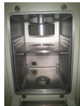
Figura III.11. Medida de espectros por espectrometría de partículas alfa. Detalle de la cámara, detector y distancia a la fuente.
