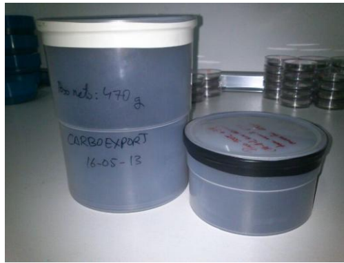
Figura III. 3. Geometrías Marinelli utilizadas para la medida por espectrometría de radiación gamma.
