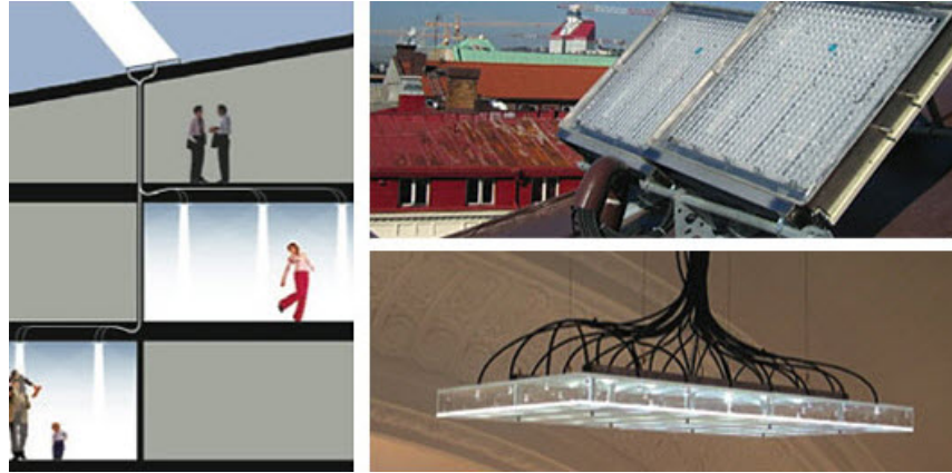
Ilustración 1 Sistema de iluminación interior mediante fibra óptica
