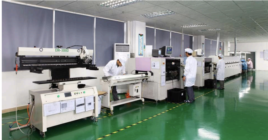
Ilustración 22: Línea de fabricación de placas LED.
