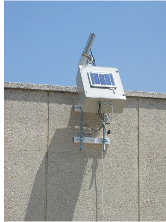
Figura 3.3: Fotografía de la instalación del fotómetro CIMEL CE318 en la estación de Cáceres.
