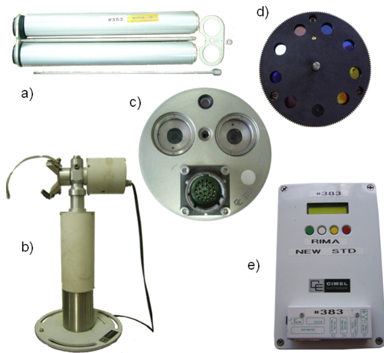
Figura 3.4: Partes que componen los fotómetros CIMEL CE318.
