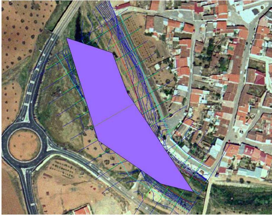
Fig. 70. Llanura de inundabilidad de Palomas con topografía digitalizada a escala 1:1.000.
