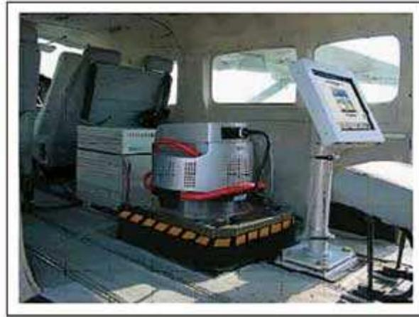
Fig. 8. Cámara digital en avión.
