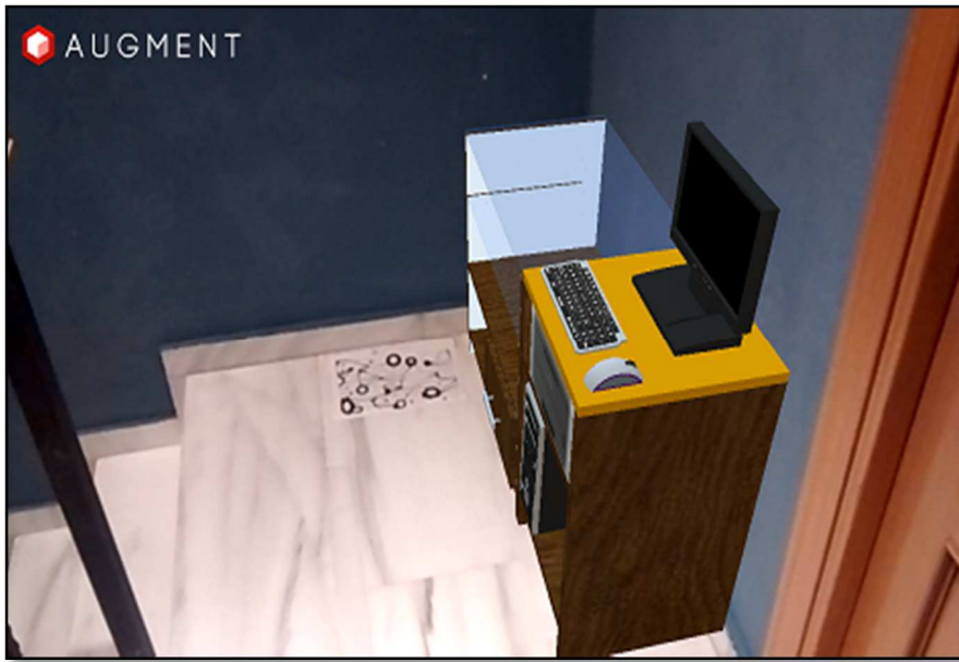
Figura 5.20 Augment®. Replanteo de elemento mostrador en entorno real.
