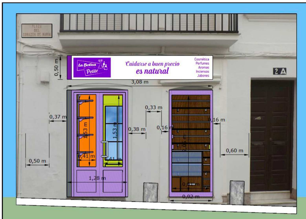
Figura 5.104. Toma de datos. Acotaciones de fachada.
