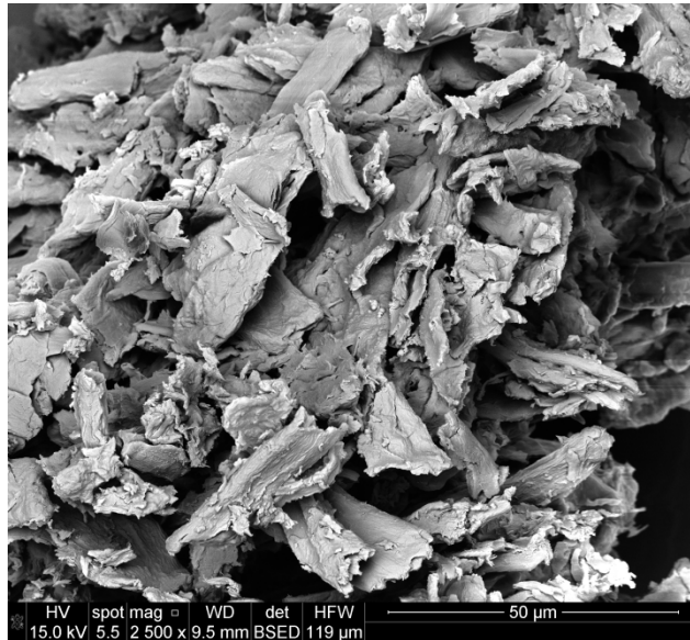
Figura 4.2-11. Microscopía SEM de la muestra 8 (170°C; 20 h; 15%)
