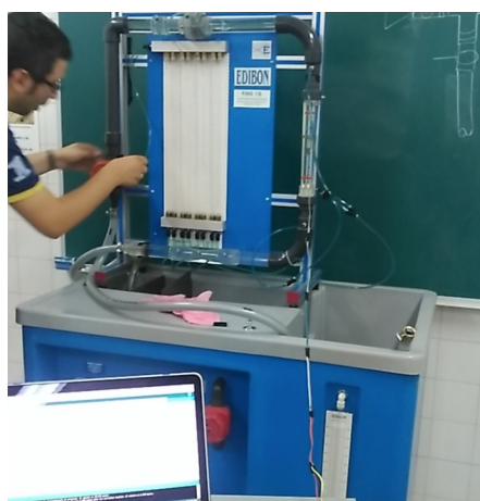
Figure 88: Instalación sensor presión.
