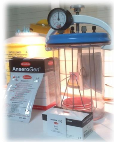
Figura 11. Jarra de anaerobiosis, sobre generador de la misma e indicador de la atmósfera anaerobia.
