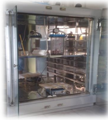
Figura 12. Estufa de cultivo programada a 42 °C.
