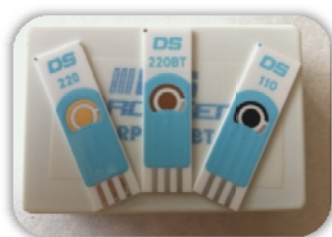
Figura 2.14. Electrodos impresos utilizados (de izquierda a derecha 220AT, 220BT, 110GNP)
