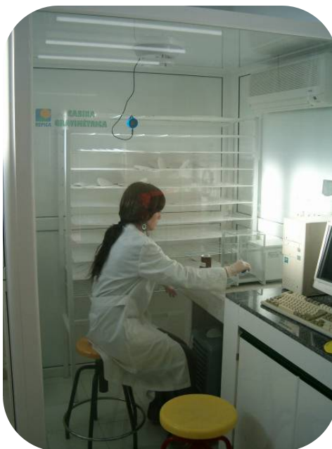
Figura 2.10. Cabina para la determinación gravimétrica del material particulado
