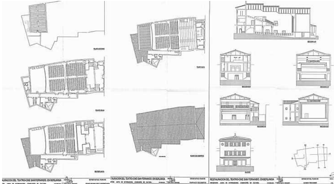
Figura 925. Plano sin reformar de planta sótano, baja y entreplanta. Figura 926. Plano sin reformar de planta alta y cubiertas. Figura 927. Estado sin reformar, plano de alzados y secciones (PRIETO FERNÁNDEZ, J., 2000).
