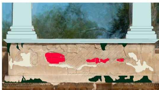
Figuras 218 y 219. Mapeado de daños antes de la intervención y reposición de enlucido de mortero de cal (LUENGO, F. y PEREZ CHIVITE, M.P., 2014).
