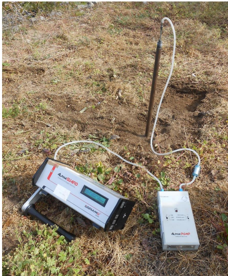
Figura 4.29: Colocación de la instrumentación para la medida de ^{222}\text{Rn} en suelos (elaboración propia).
