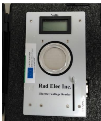
Figura 4.18: Voltímetro para medir la tensión de la superficie (elaboración propia).
