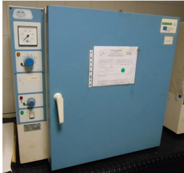
Figura 4.10: Estufa utilizada para el reciclado de las c nister (elaboraci n propia).
