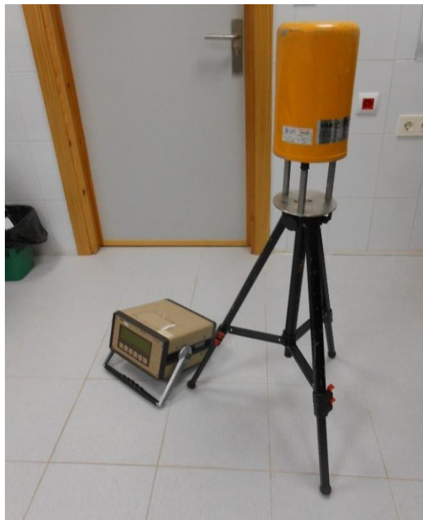
Figura 4.24: Contador proporcional sellado midiendo en interior (elaboración propia).
