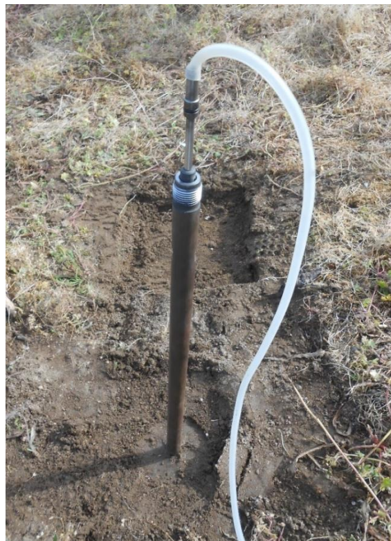
Figura 4.28: Sonda utilizada para la medida de ^{222}\text{Rn} en suelos (elaboración propia).
