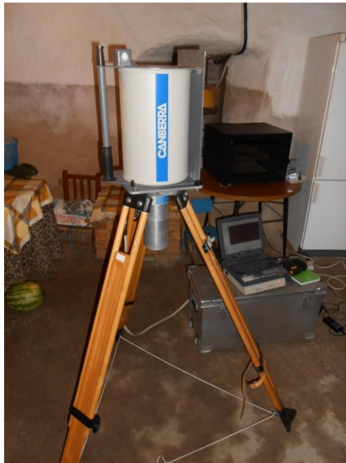
Figura 4.25: Detector de HPGe midiendo en el interior de una vivienda (elaboración propia).
