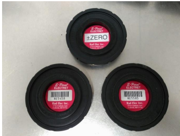
Figura 4.19: Electrete utilizado para ajustar el voltímetro a 0 (arriba), y los dos electretes de control (debajo), (elaboración propia).
