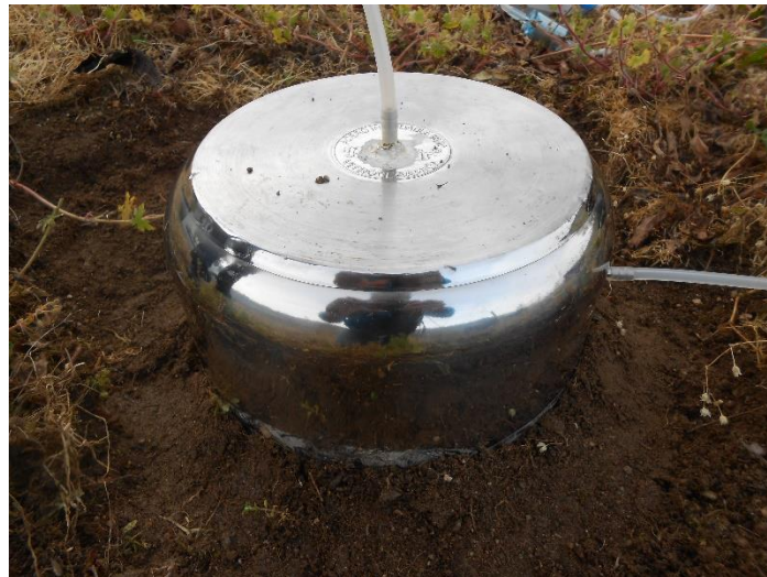
Figura 4.26: Recipiente utilizado para la medida de exhalación de ^{222}\text{Rn} en suelos (elaboración propia).
