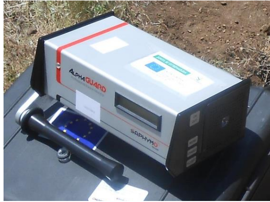
Figura 4.12: Instrumento de lectura continua de ^{222}\text{Rn} , Alphaguard (elaboración propia).
