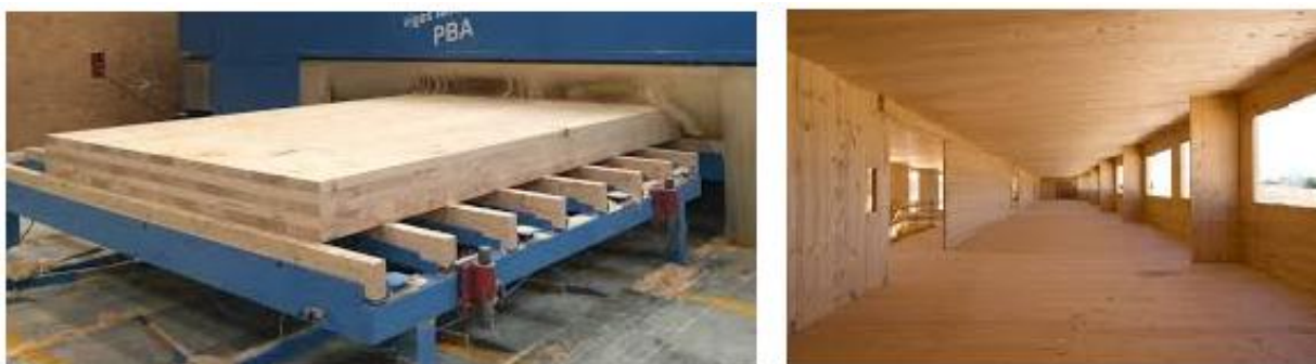
Ilustración 23 Sistema constructivo con tableros contralaminados
