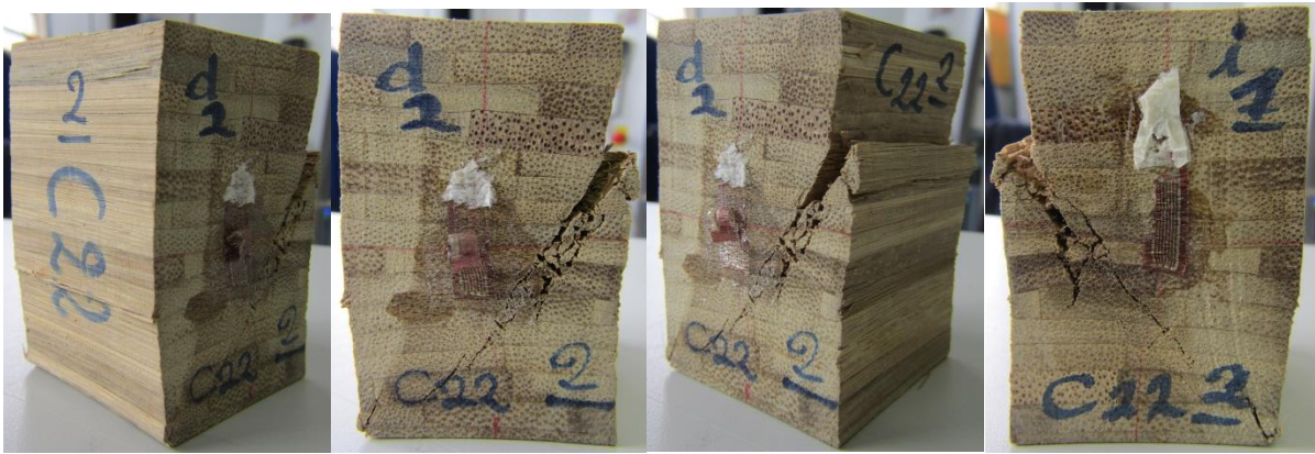
Figura 4-54 Ensayo a compresión paralela a la fibra probeta C22-2 estado final
