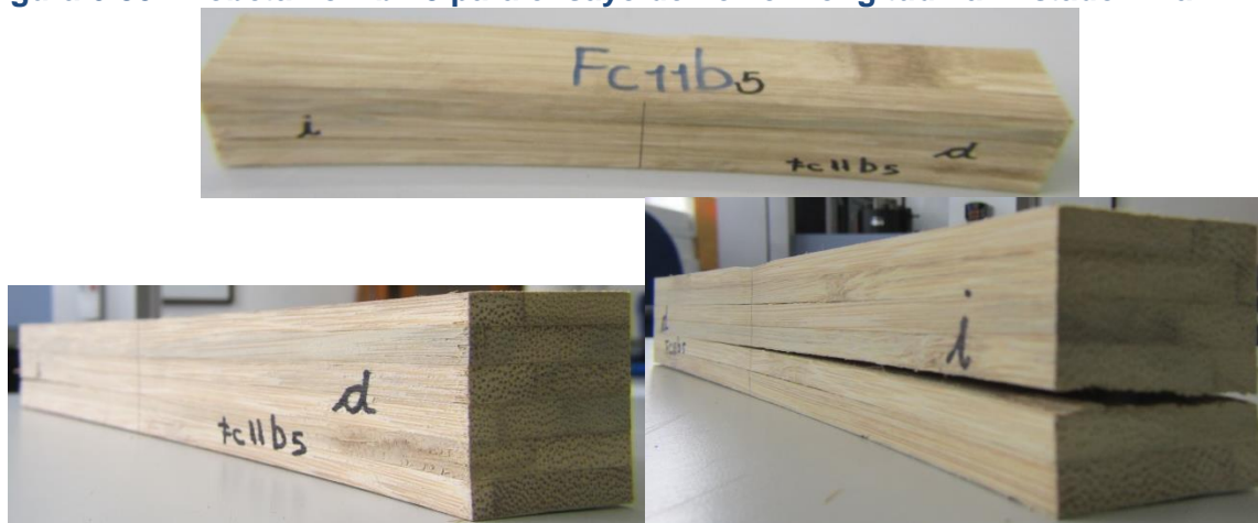
Figura 6-30. Probeta Fc11b - 5 para ensayo de flexión longitudinal. Estado Final
