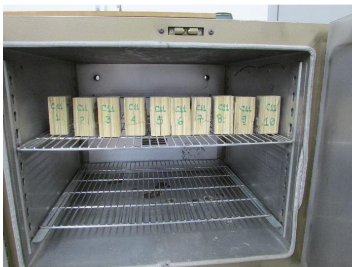
Figura 4-38. Determinación del Contenido de Humedad serie C11, ingreso al horno.
