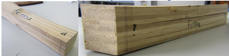
Figura 6-6 Probeta Fc11a - 2 para ensayo de flexión longitudinal. Estado Final
