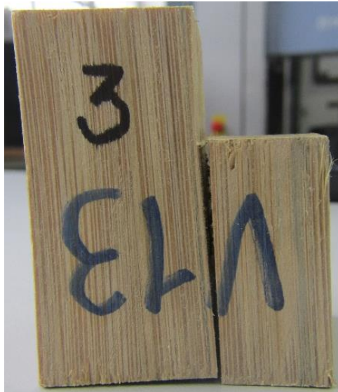
Figura 5-8 Ensayo Cortante Paralelo a la Fibra probetas V13 – 3 estado final
