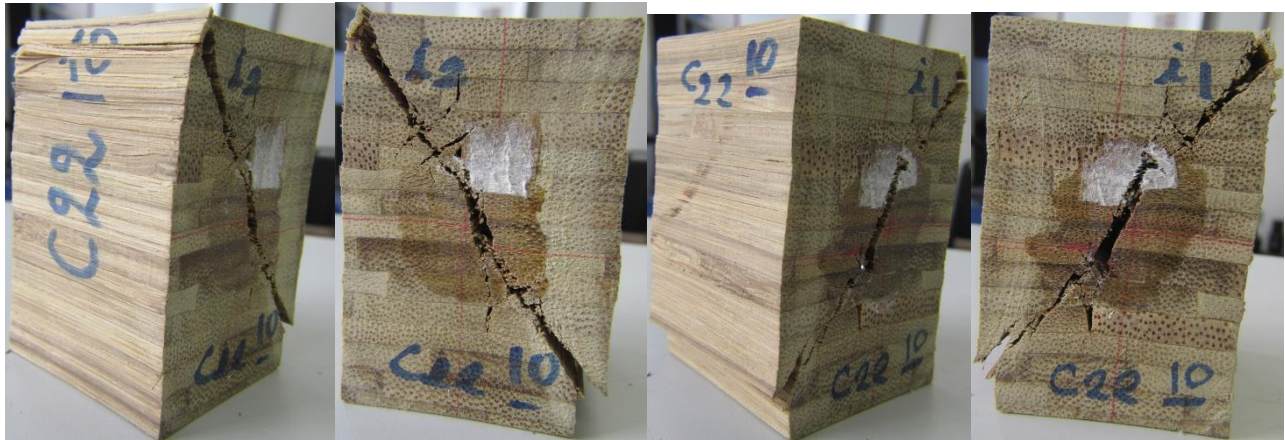
Figura 4-62 Ensayo a compresión paralela a la fibra probeta C22-10 estado final
