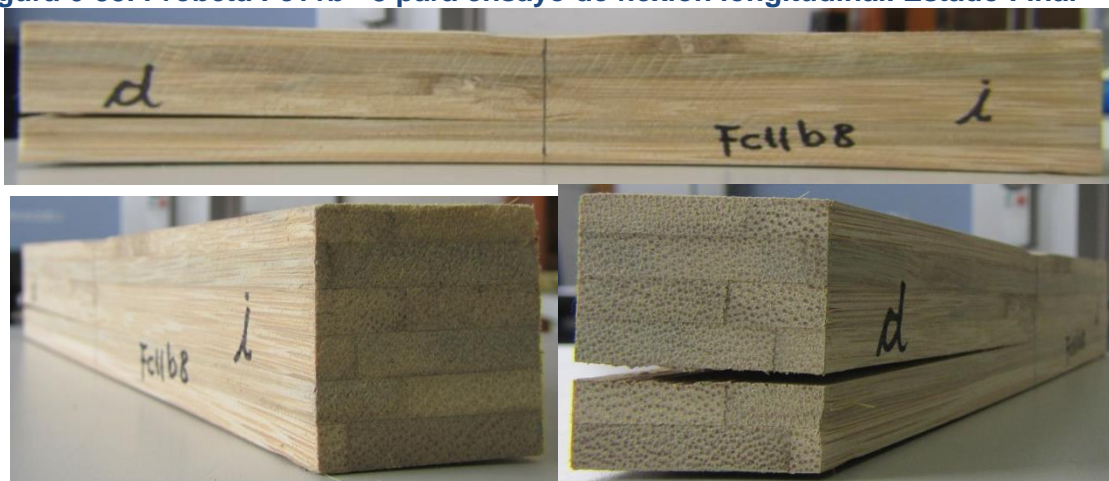
Figura 6-33. Probeta Fc11b - 8 para ensayo de flexión longitudinal. Estado Final
