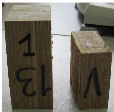
Figura 5-6. Ensayo Cortante Paralelo a la Fibra probetas V13 – 1 estado final
