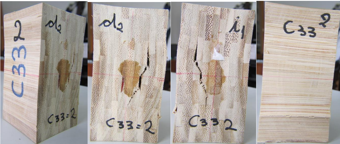
Figura 4-91. Ensayo a compresión perpendicular a la fibra paralela al plano de unión entre tableros en probeta C33-2 estado final
