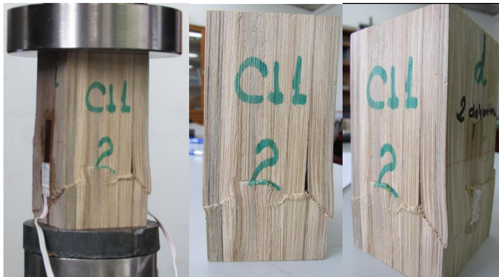
Figura 4-19 Ensayo a compresión paralela a la fibra probeta C11-2 estado final
