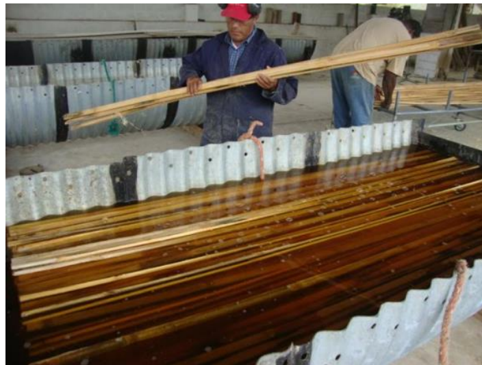
Figura 3-8. Preservado. Se sumergen las latillas en agua con preservantes.
