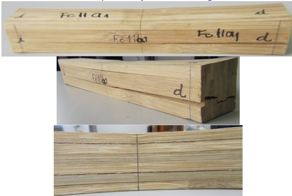
Figura 6-5 Probeta Fc11a - 1 para ensayo de flexión longitudinal. Estado Final
