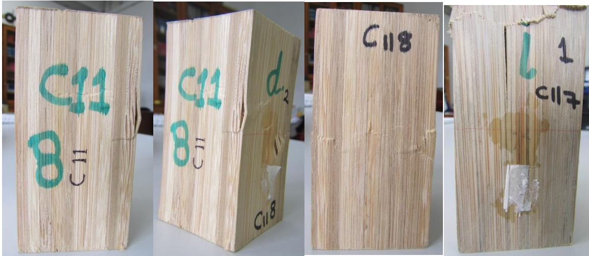
Figura 4-24 Ensayo a compresión paralela a la fibra probeta C11-8 estado final
