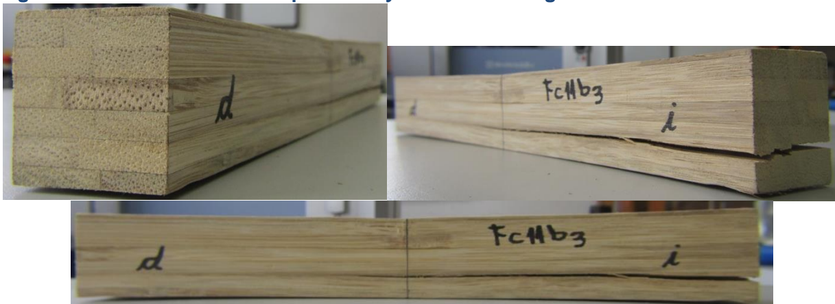
Figura 6-28. Probeta Fc11b - 3 para ensayo de flexión longitudinal. Estado Final
