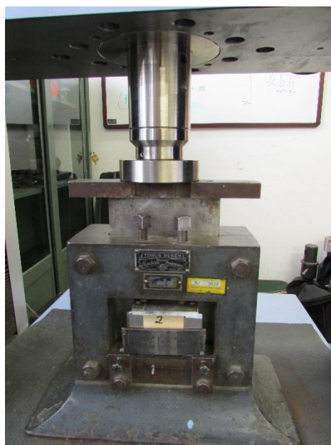
Figura 5.3 Ubicación de probeta V13 en la máquina Universal con un dispositivo para la sujeción.
