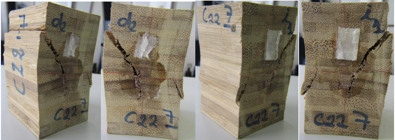
Figura 4-59 Ensayo a compresión paralela a la fibra probeta C22-7 estado final
