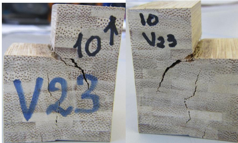
Figura 5-63. Ensayo Cortante Perpendicular a la Fibra en probetas V23 – 10 estado final
