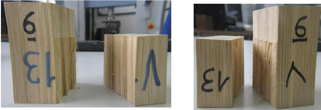
Figura 5-11. Ensayo Cortante Paralelo a la Fibra probetas V13 – 6 estado final
