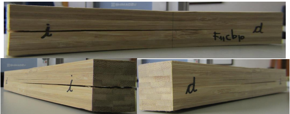
Figura 6-35. Probeta Fc11b - 10 para ensayo de flexión longitudinal. Estado Final
