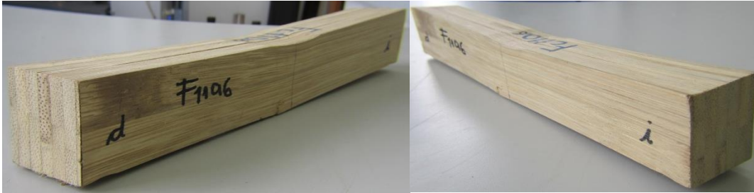
Figura 6-11 Probeta Fc11a - 7 para ensayo de flexión longitudinal. Estado Final.
