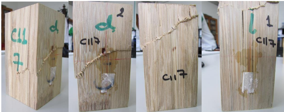
Figura 4-23 Ensayo a compresión paralela a la fibra probeta C11-7 estado final
