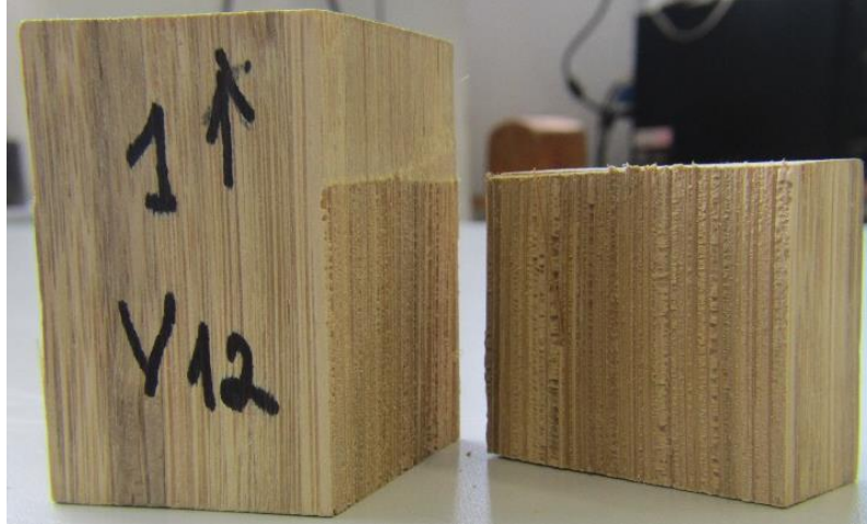
Figura 5-31. Ensayo Cortante Paralelo a la Fibra probetas V12 – 1 estado final
