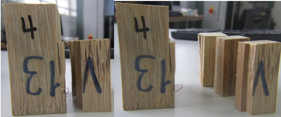
Figura 5-9. Ensayo Cortante Paralelo a la Fibra probetas V13 – 4 estado final
