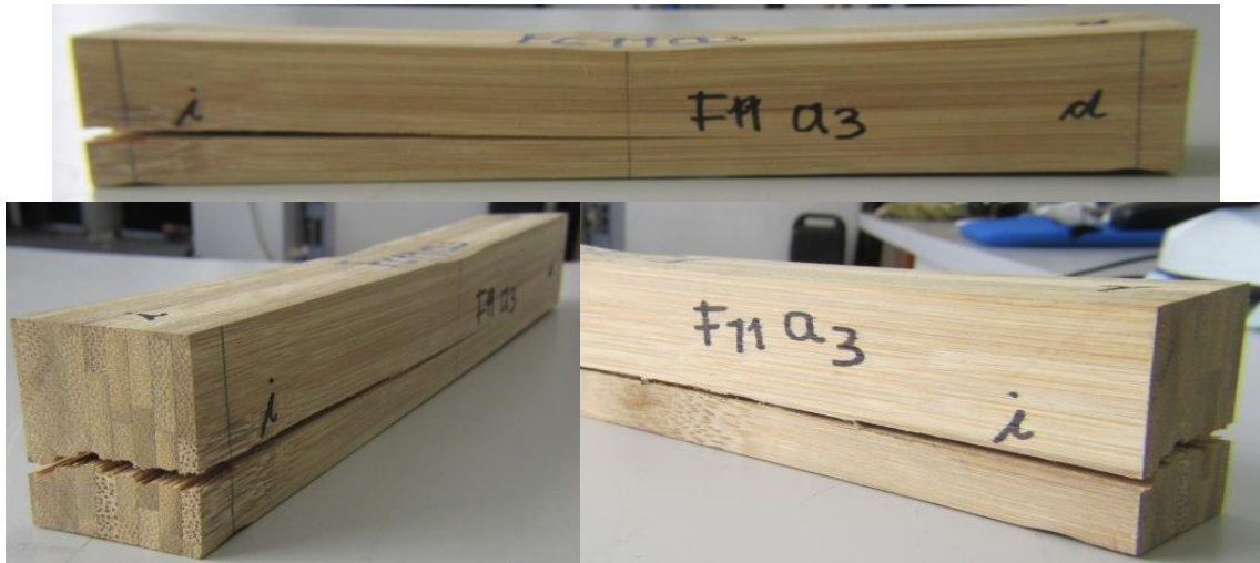
Figura 6-8 Probeta Fc11a - 4 para ensayo de flexión longitudinal. Estado Final
