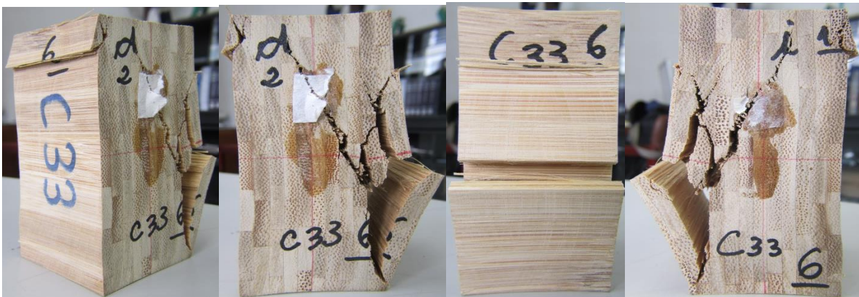
Figura 4-95. Ensayo a compresión perpendicular a la fibra paralela al plano de unión entre tableros en probeta C33-6 estado final
