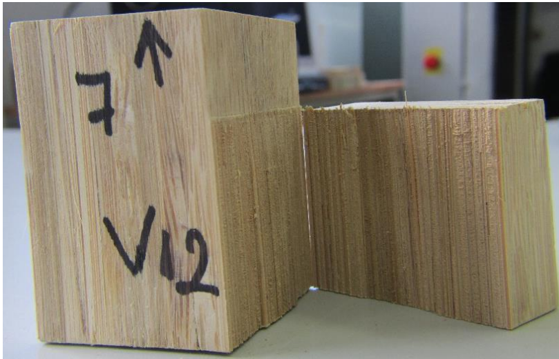
Figura 5-37. Ensayo Cortante Paralelo a la Fibra probetas V12 – 7 estado final
