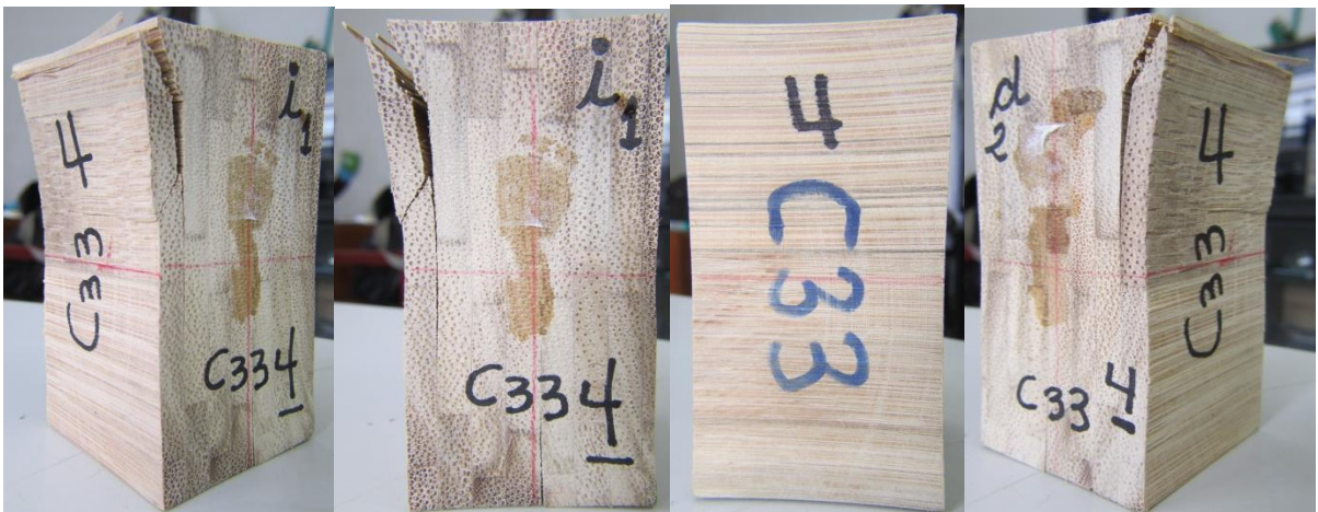
Figura 4-93. Ensayo a compresión perpendicular a la fibra paralela al plano de unión entre tableros en probeta C33-4 estado final
