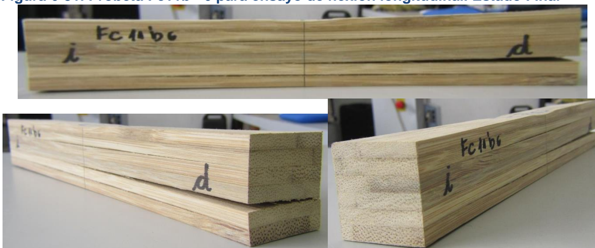
Figura 6-31. Probeta Fc11b - 6 para ensayo de flexión longitudinal. Estado Final
