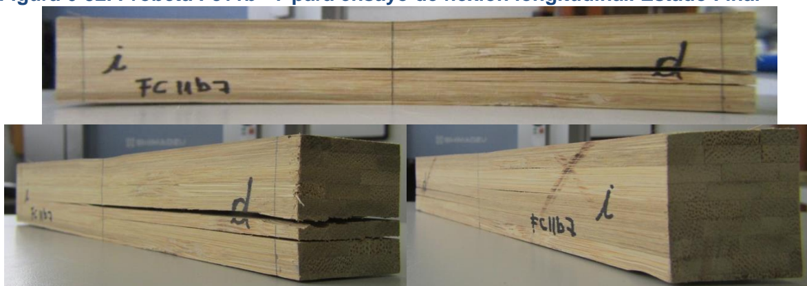
Figura 6-32. Probeta Fc11b - 7 para ensayo de flexión longitudinal. Estado Final
