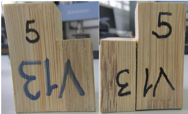
Figura 5-10. Ensayo Cortante Paralelo a la Fibra probetas V13 – 5 estado final
