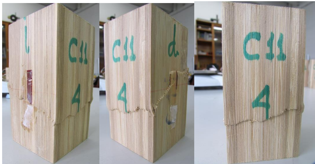
Figura 4-21 Ensayo a compresión paralela a la fibra probeta C11-4 estado final
