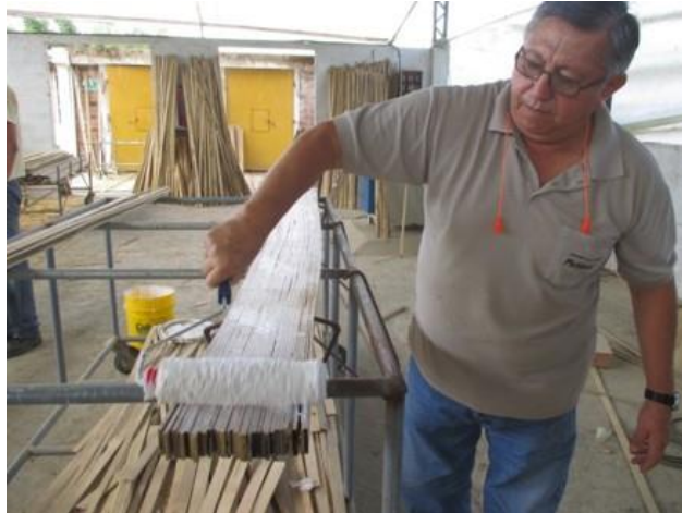
Figura 3-14. Armado de tablero y encolado.
