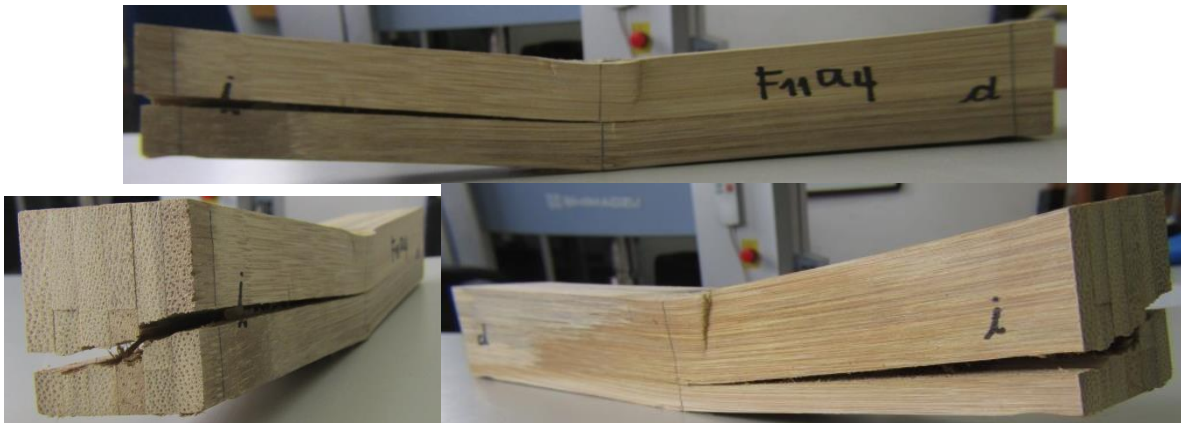
Figura 6-9 Probeta Fc11a - 5 para ensayo de flexión longitudinal. Estado Final
