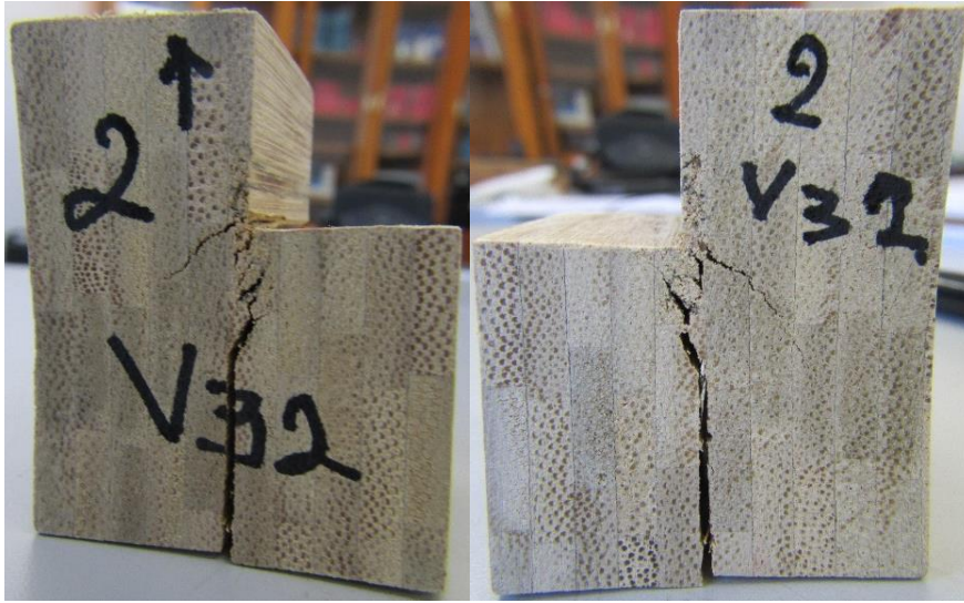
Figura 5-78 Ensayo Cortante Perpendicular a la Fibra Probeta V32-2. Estado final
