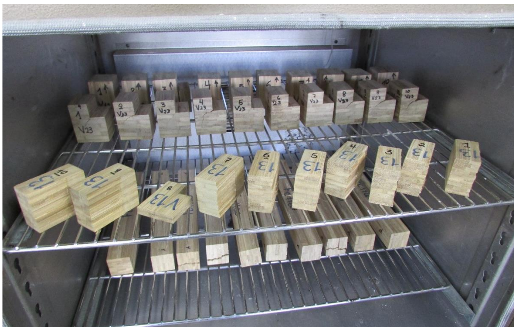
Figura 5-27 Ingreso al horno de las probetas V13
