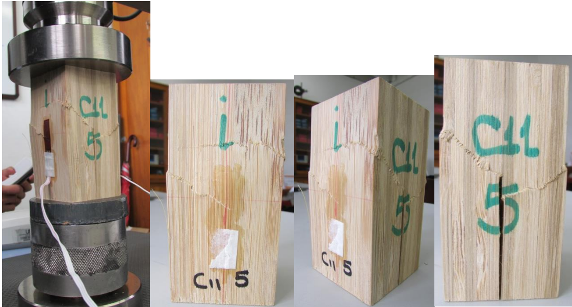
Figura 4-22 Ensayo a compresión paralela a la fibra probeta C11-5 estado final
