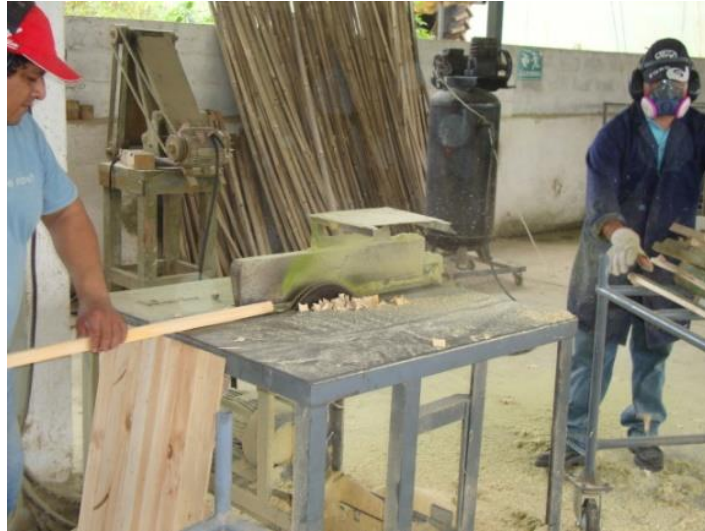
Figura 3-12. Cepillado de una cara.
