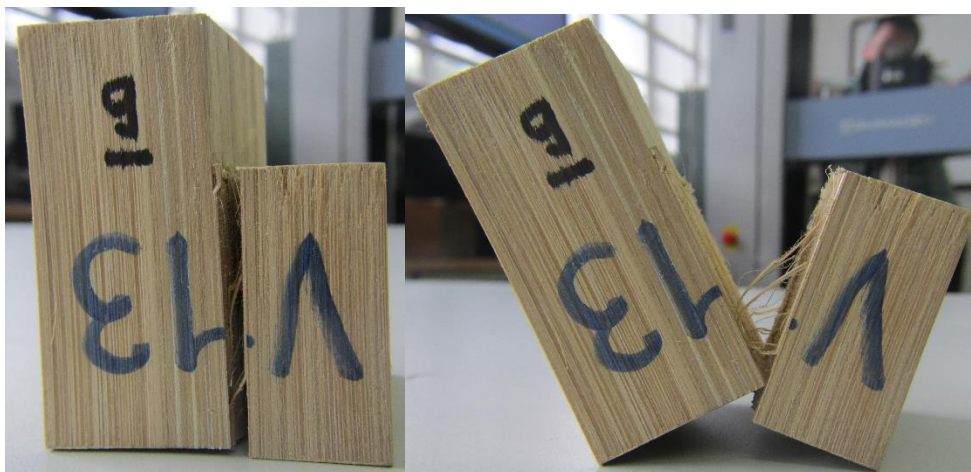
Figura 5-14. Ensayo Cortante Paralelo a la Fibra probetas V13 – 9 estado final
