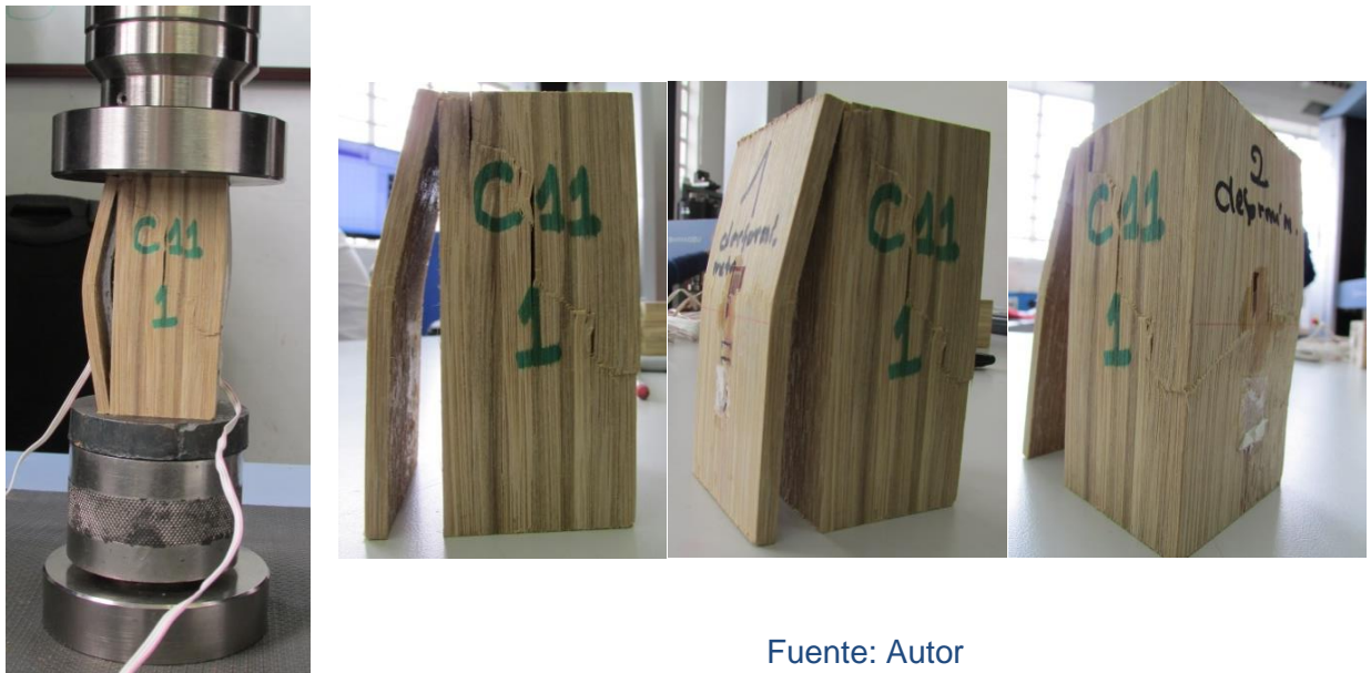
Figura 4-18 Ensayo a compresión paralela a la fibra probeta C11-1 estado final
