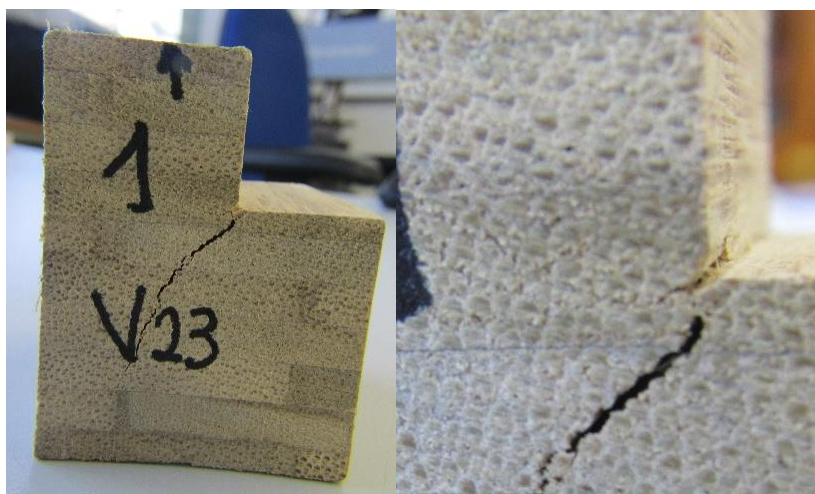
Figura 5-54 Ensayo Cortante Perpendicular a la Fibra en probetas V23 – 1 estado final
