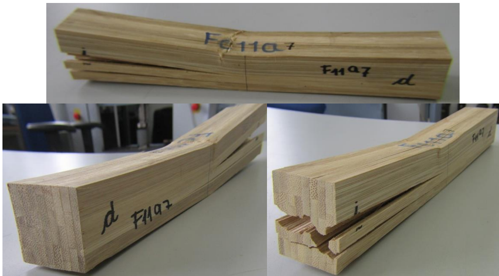
Figura 6-12 Probeta Fc11a - 8 para ensayo de flexión longitudinal. Estado Final.
