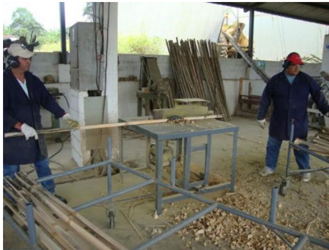
Figura 3-6 Denudado de las latillas de bambú.
