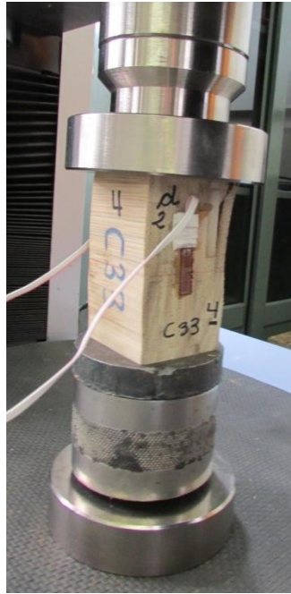
Figura 4-75. Ubicación de deformímetros en las Probetas ensayadas a compresión perpendicular a la fibra paralela al plano de unión entre tableros en probetas Series C33
