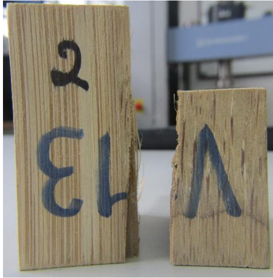
Figura 5-7. Ensayo Cortante Paralelo a la Fibra probetas V13 – 2 estado final
