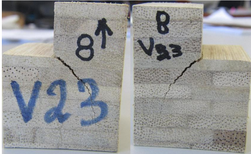
Figura 5-61. Ensayo Cortante Perpendicular a la Fibra en probetas V23 – 8 estado final
