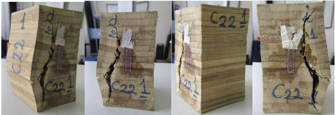
Figura 4-53 Ensayo a compresión paralela a la fibra probeta C22-1 estado final
