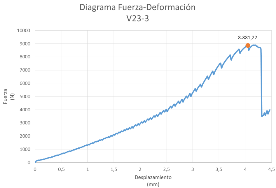
Figura 5-66. Relación carga-desplazamiento, muestra V23-3
