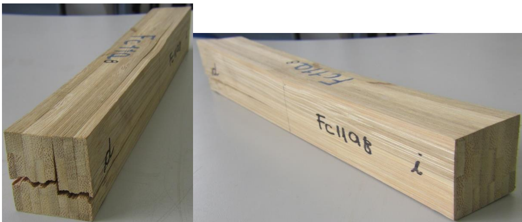
Figura 6-12 Probeta Fc11a - 8 para ensayo de flexión longitudinal. Estado Final.
