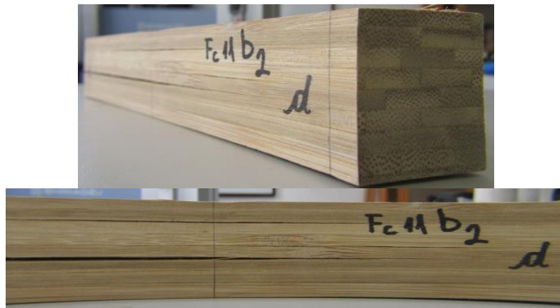
Figura 6-27. Probeta Fc11b - 2 para ensayo de flexión longitudinal. Estado Final
