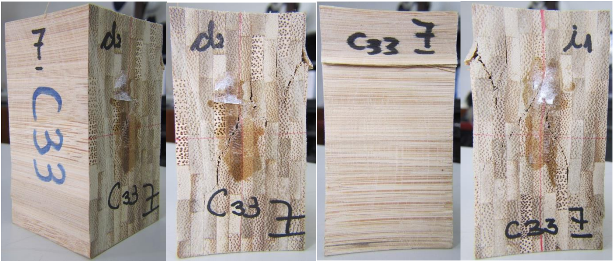
Figura 4-96. Ensayo a compresión perpendicular a la fibra paralela al plano de unión entre tableros en probeta C33-7 estado final
