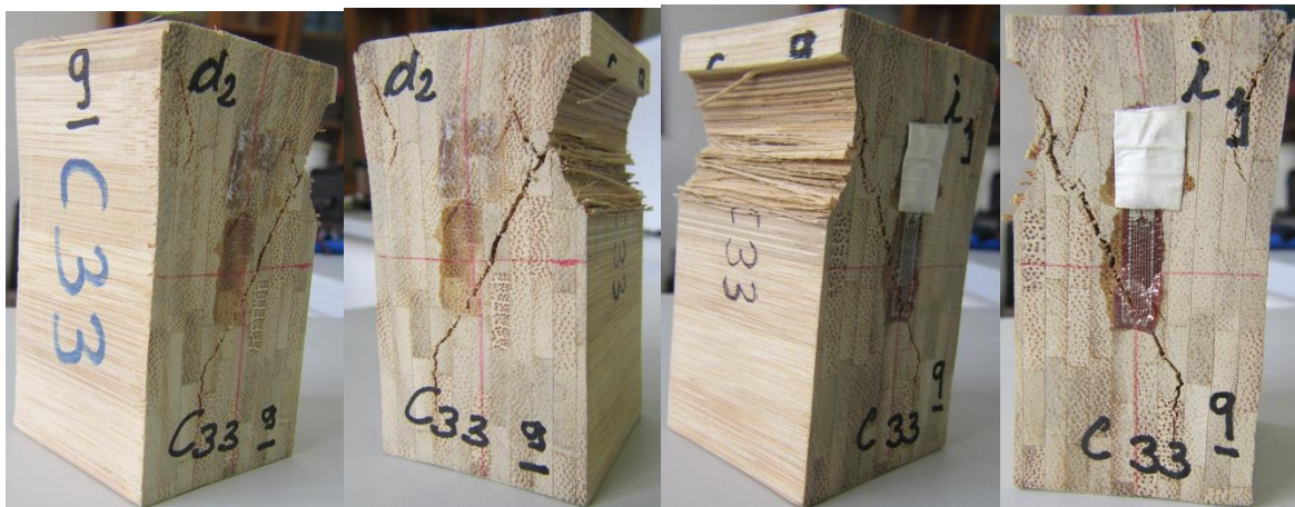
Figura 4-98. Ensayo a compresión perpendicular a la fibra paralela al plano de unión entre tableros en probeta C33-9 estado final
