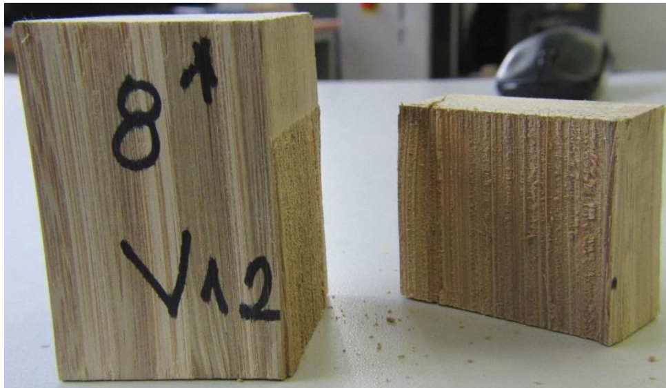
Figura 5-38. Ensayo Cortante Paralelo a la Fibra probetas V12 – 8 estado final
