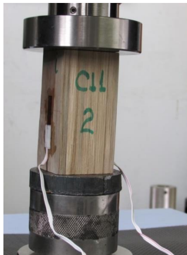
Figura 4-4 Colocación de deformímetros para ensayo de compresión paralela a la fibra.
