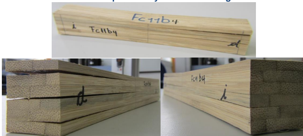
Figura 6-29. Probeta Fc11b - 4 para ensayo de flexión longitudinal. Estado Final
