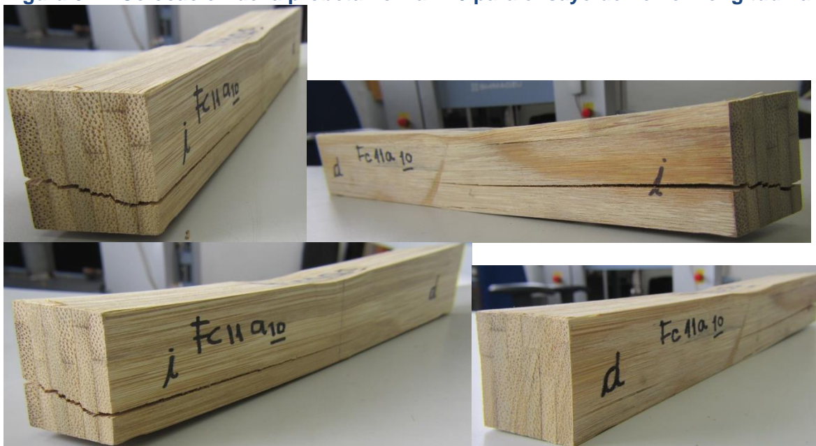
Figura 6-14 Colocación de la probeta Fc11a - 10 para ensayo de flexión longitudinal.
