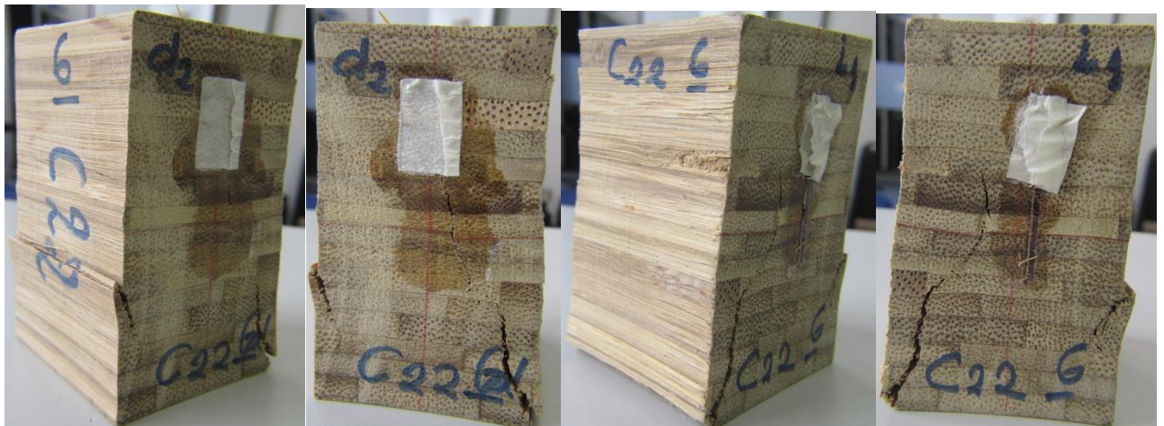
Figura 4-58 Ensayo a compresión paralela a la fibra probeta C22-6 estado final
