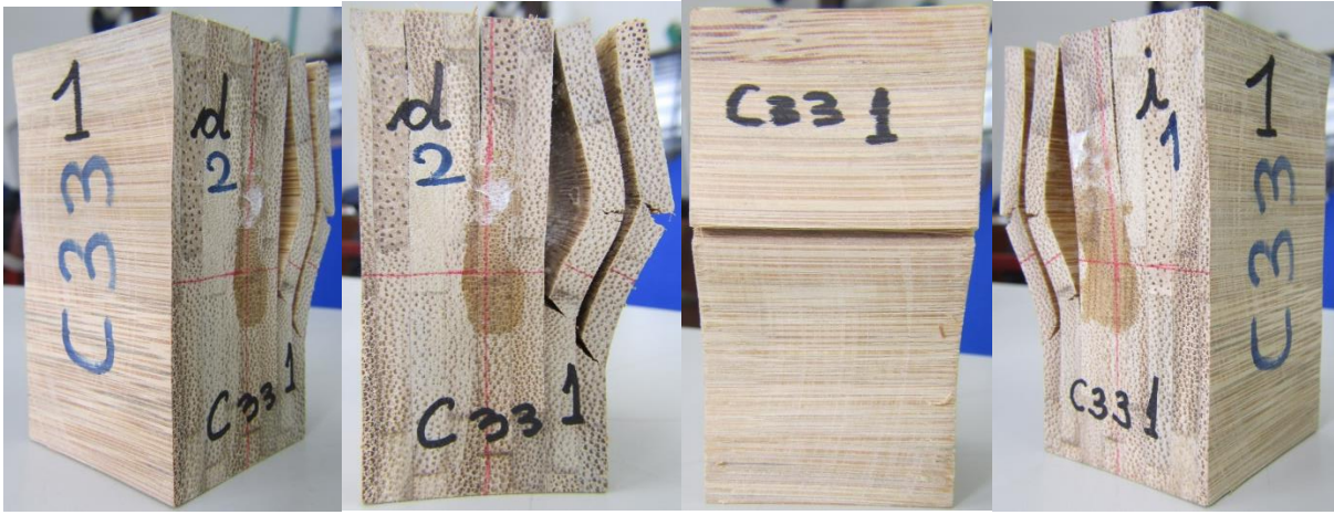
Figura 4-90. Ensayo a compresión perpendicular a la fibra paralela al plano de unión entre tableros en probeta C33-1 estado final
