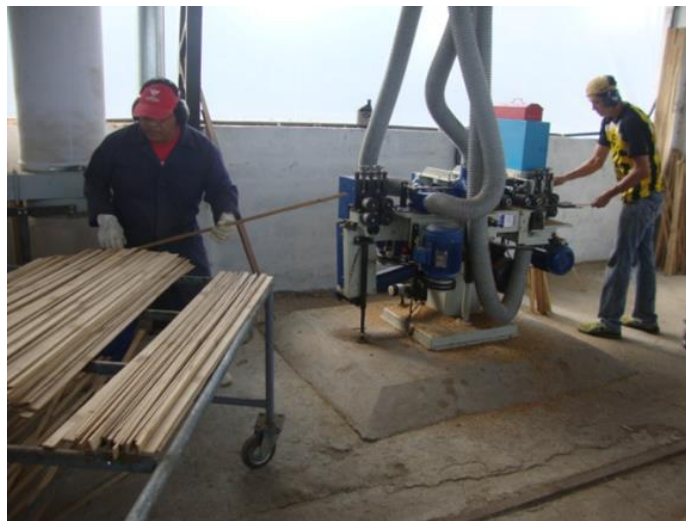
Figura 3-13. Cepillado 4 caras latillas.
