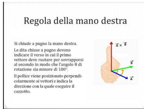
Figura 3.32: Illustrazione della regola della mano destra.
