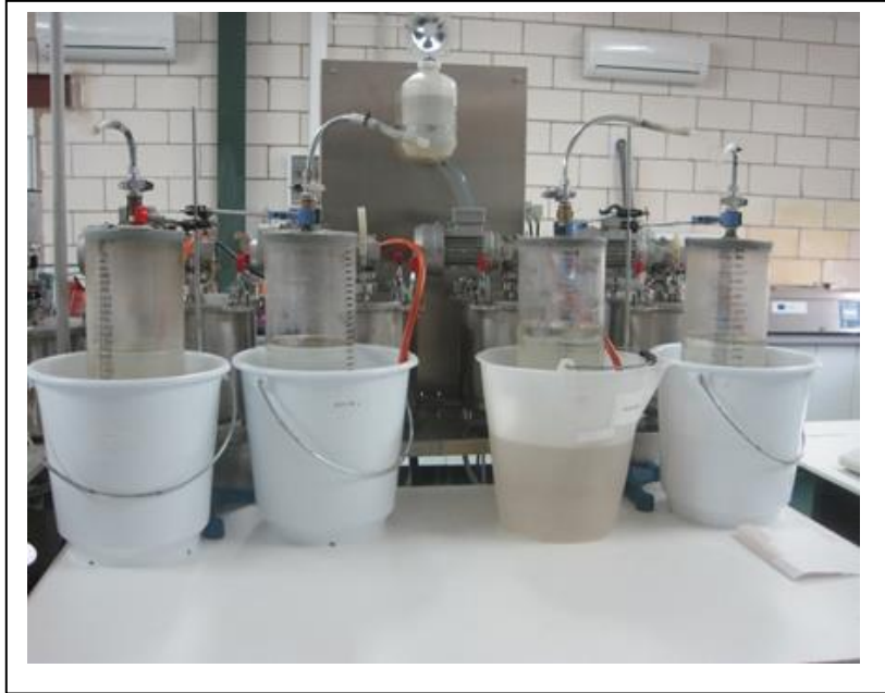
Fig. 2.6. Columnas invertidas para la medición del biogás
