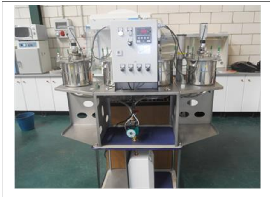
Fig. 2.3. Digestor anaerobio Lehman Maschinenbau
