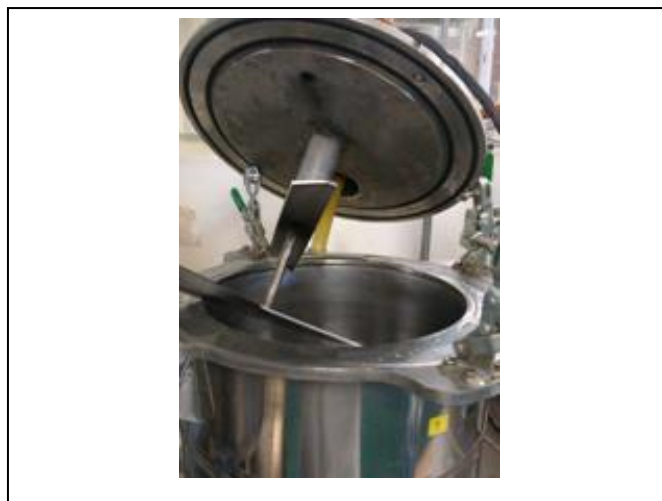
Fig. 2.5. Hélices de agitación del digestor.
